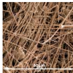
Abbildung 3 Mikroskopieaufnahme von Steinwolle
