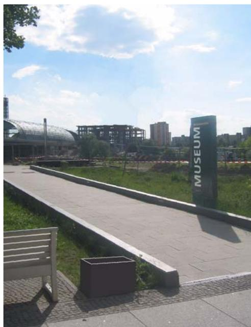
Der Zugang zum Museumseingang wurde als befahrbarer Weg mit geringem Gefälle aber ohne Stufen ausgeführt.
