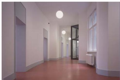
Ein breiter Flur ermöglicht die Begegnung von Rollstuhlnutzern; außerdem gut: Blendfreie Ausleuchtung, rutschfester Bodenbelag und farblich (leicht) abgehobene Türfassungen.
