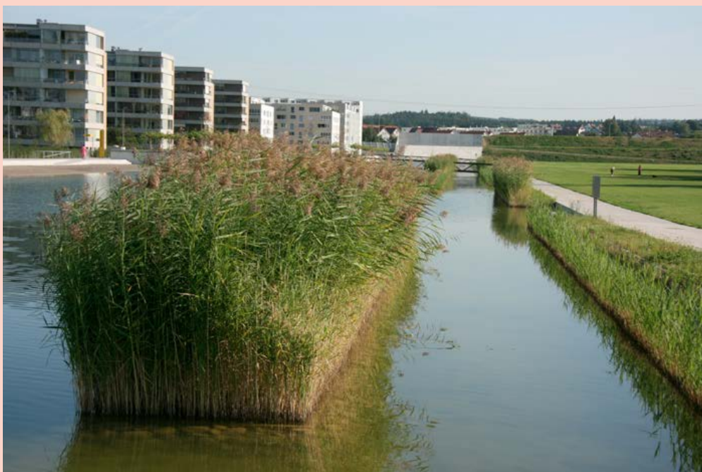
Der Opfikerpark im neuen Stadtteil Glattpark in Opfikon-Zürich. Der See wird vor allem durch Dachwasser der angrenzenden Quartiere gespeist. Schilfanpflanzungen sorgen für eine gute Wasserqualität (Fotos: A. Stokmann)
