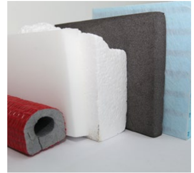
In Baumaterialien aus Kunststoffen ist der Einsatz von Flammschutzmitteln weit verbreitet.
