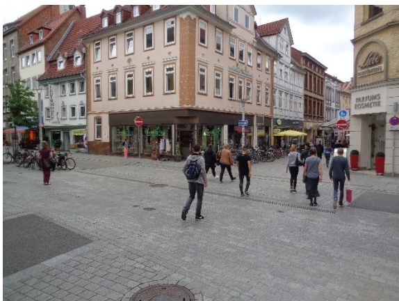
Flächige Pflasterungen auf der Fahrbahn verdeutlichen Querungsbeziehungen Foto: Manuel Weiß
