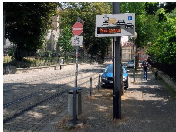
Sensorgestütztes Display mit Hinweis auf genügend Abstand zum Gleisbett beim Parken Foto: Manuel Weiß
