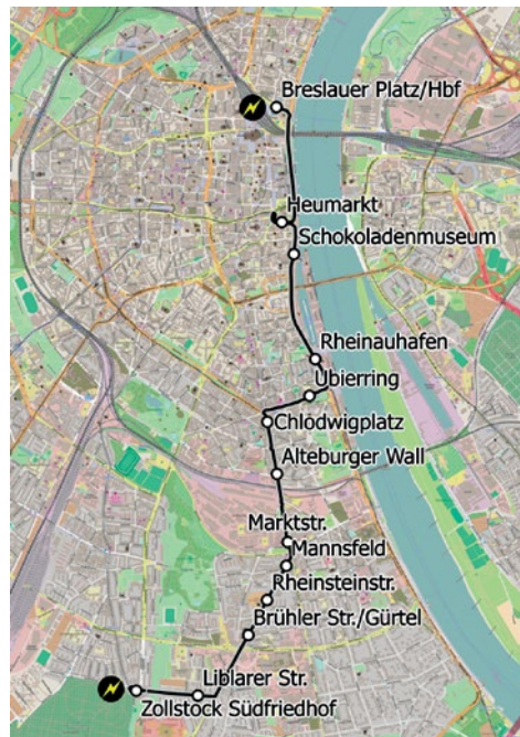
Abbildung 8 E-Bus-Linie 133 in Köln. Die Blitze markieren die Ladepunkte an den Endhaltestellen
