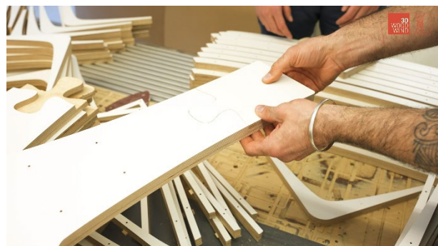
Abb. 67 Überprüfung der Toleranzen anhand der Puzzle-Verbindung
