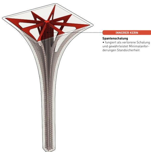
Abb. 45 Innerer Kern als verlorene Schalung
