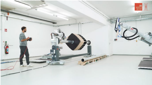
Abb. 53 Roboteranlage mit Schalungselement der Deckenmodule
