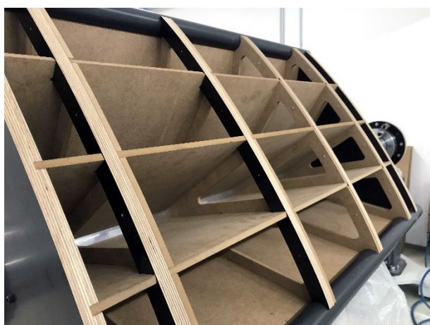
Abb. 41 Innere Struktur der Schalung
