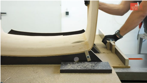
Abb. 61 Auseinandersägen der gewickelten Module auf der Kreissäge
