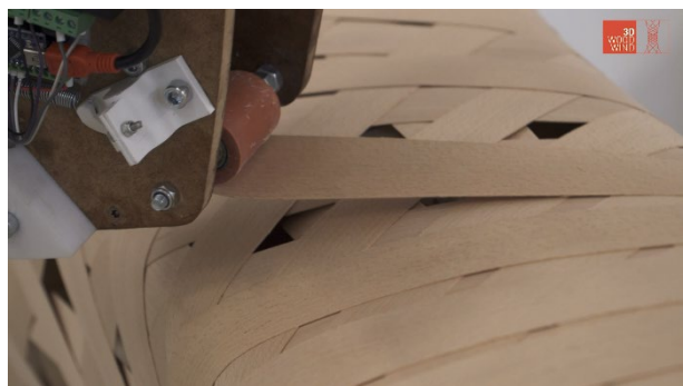
Abb. 75 Kreuzweise gewickelte Lage gegen den Uhrzeigersinn
