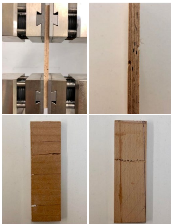
Abb. 19 Zugversuch und Versagensarten der Probekörper
