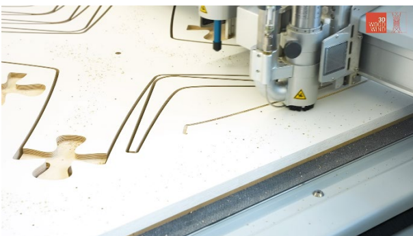
Abb. 63 CNC-gefräste Deckenplatten und Verbinderelemente
