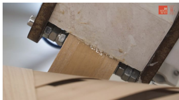
Abb. 60 Verleimung des Furniers von der Unterseite
