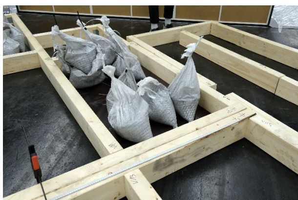
Abb. 81 Fundamente der Stützen (160mm hoch)
