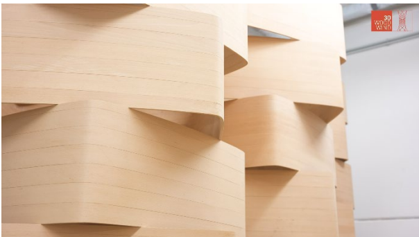
Abb. 62 Gewickelte Deckenmodule vor der Weiterverarbeitung
