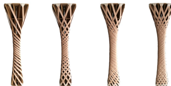
Abb. 48 Lagenaufbau der Stützen am 1:2 Modell
