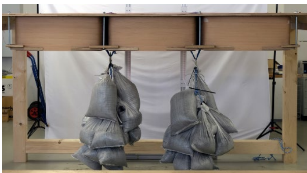
Abb. 26 Belastungstest - P_{max} : 175kg pro Punkt
