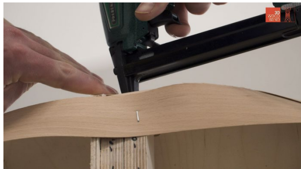
Abb. 74 Befestigung des Furniers mittels Tacker
