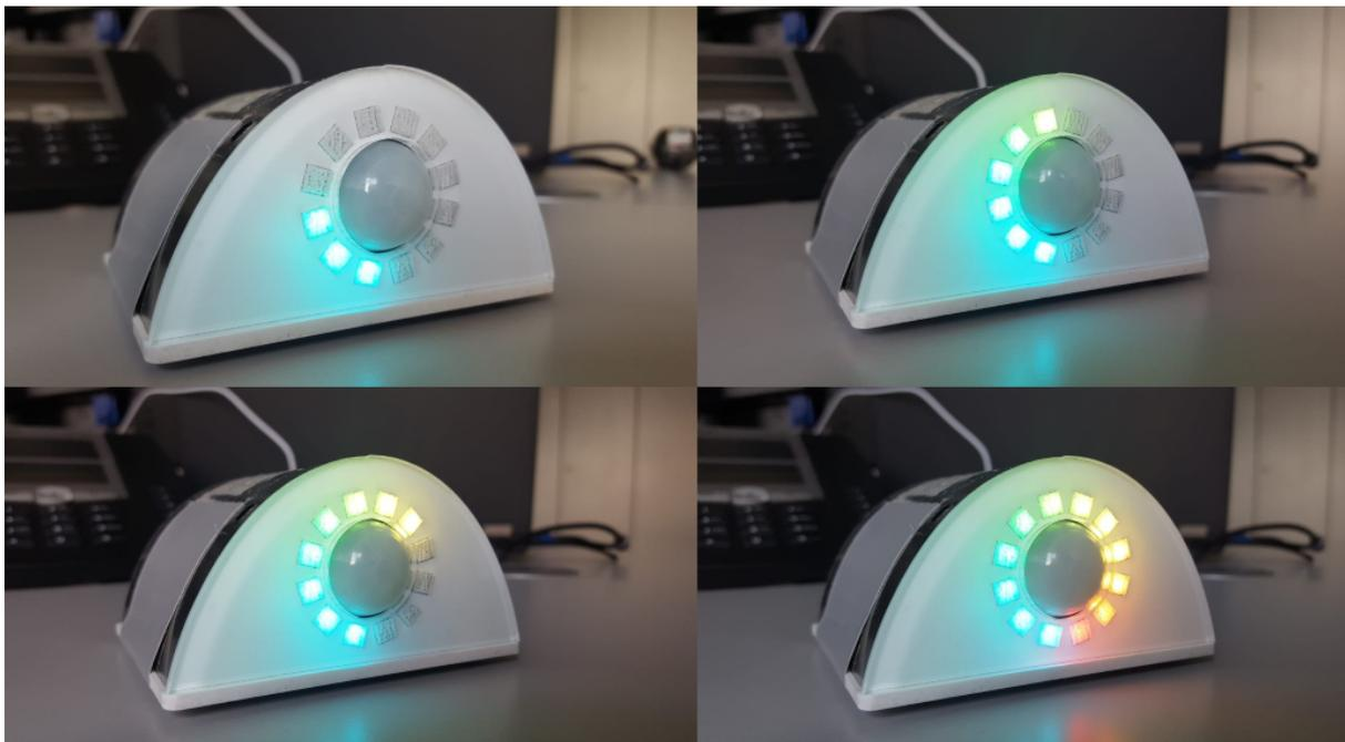
**Abbildung 2: EBZ-Lüftungsassistenzsystem "Hangar" mit der Anzeige für unterschiedliche CO<sub>2</sub>-Konzentrationen**
