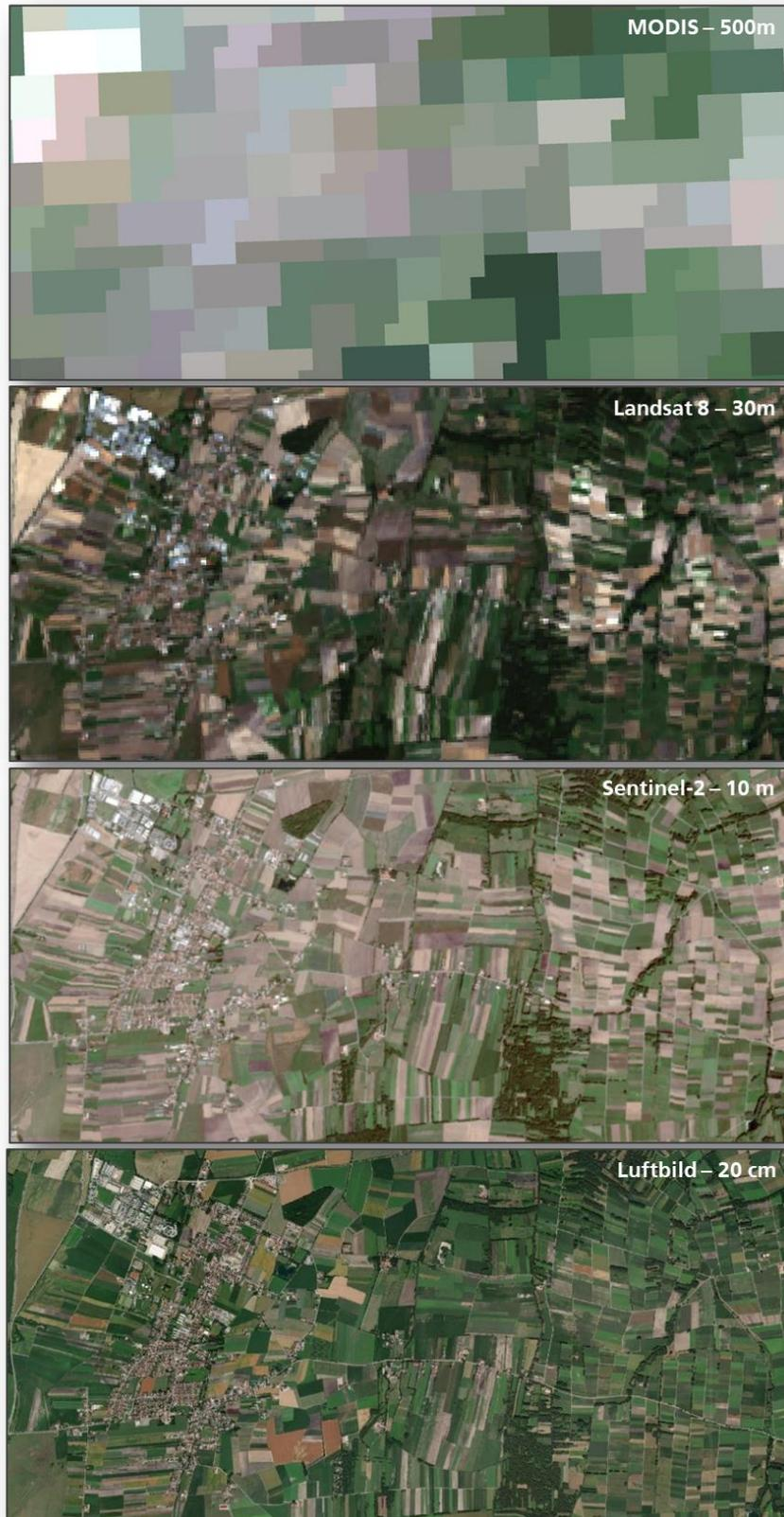
**Abbildung 4: Detaillierungsgrad unterschiedlicher geometrischer Auflösungen von Multispektralaufnahmen der Satelliten MODIS, Landsat 8 und Sentinel-2 im Vergleich zum digitalen Luftbild.** Quelle: DLR
