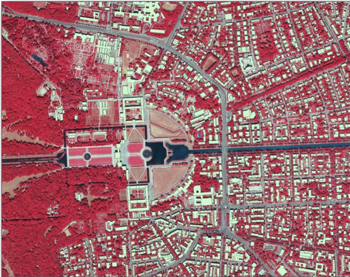
**Abbildung 3: Digitales Orthophoto (DOP20-DE®) in Falschfarbendarstellung mit nahem Infrarot, überlagert durch eine flächenhafte Darstellung der Hausumringe (HU-DE®).** Quelle: DLR\BKG
