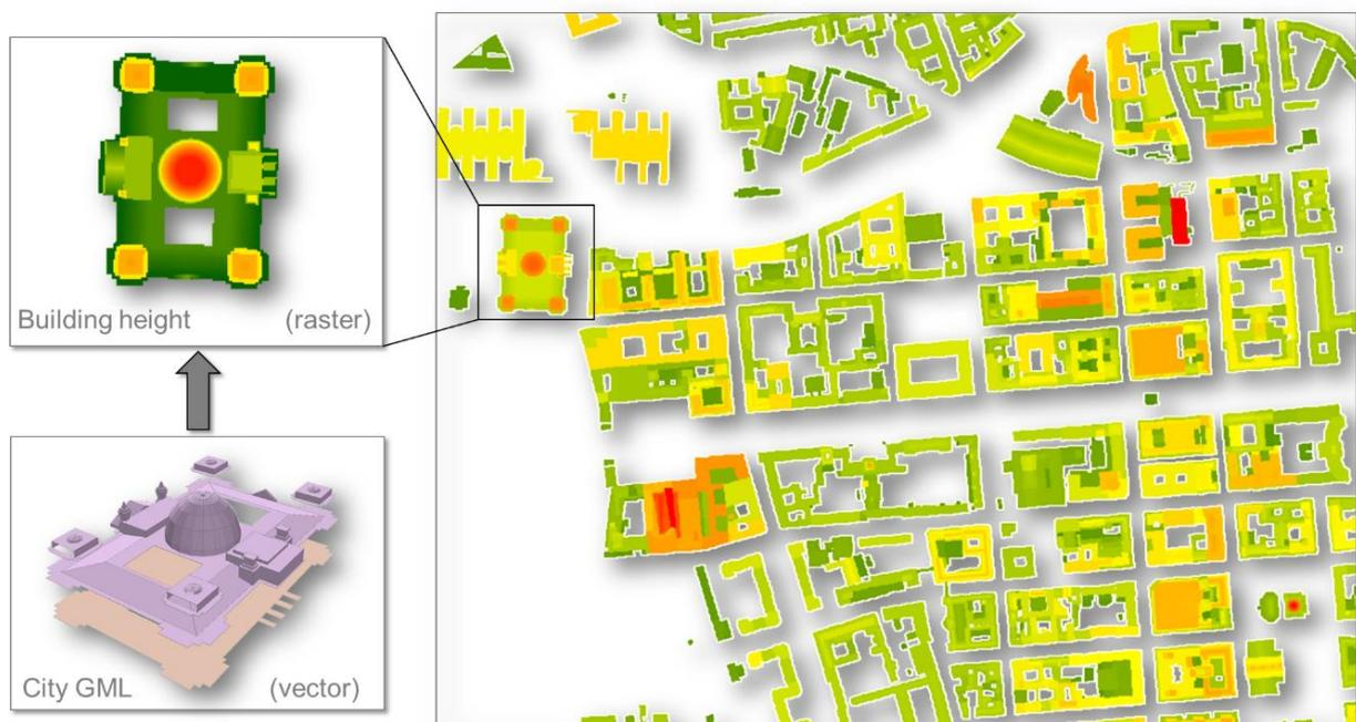
**Abbildung 2: 3D Gebäudedaten im Rasterformat und als Vektormodell (City GML) mit der Detailstufe LoD2.**
