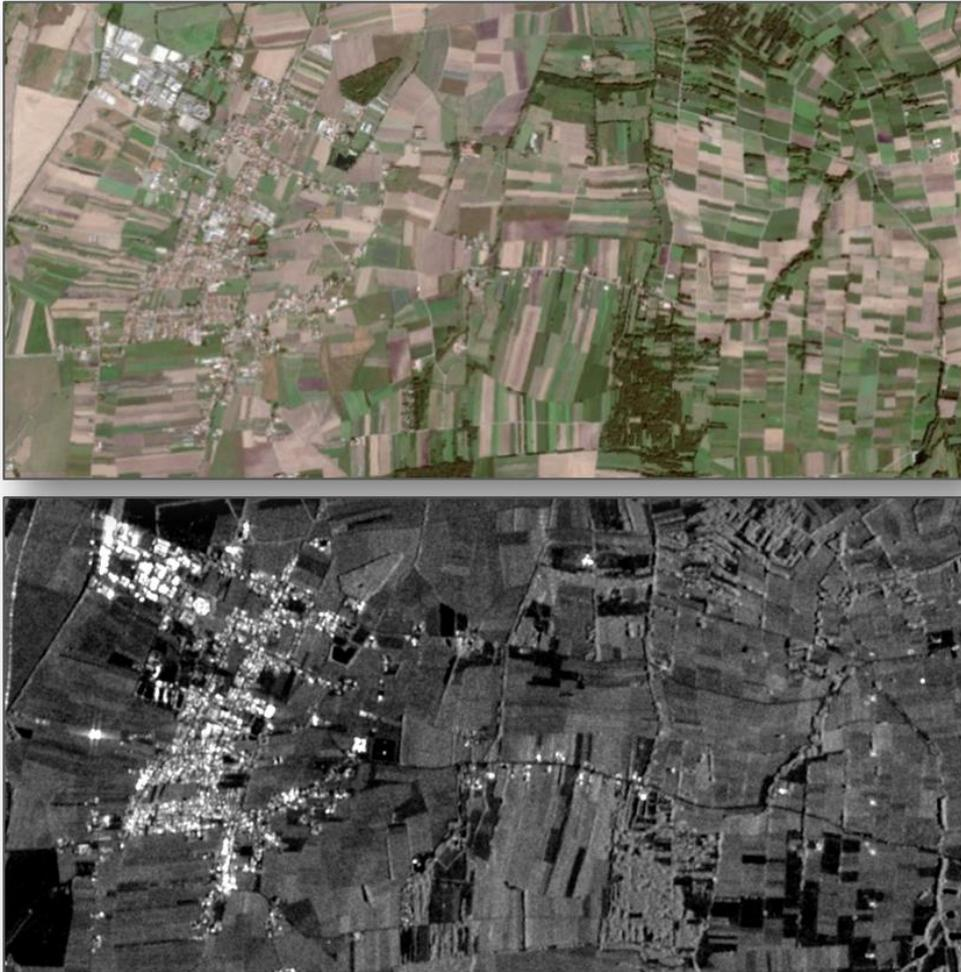
**Abbildung 7: Unterschiede zwischen einem multispektralen Satellitenbild des Sentinel-2 (oben) und einer radarbasierten Aufnahme des Sentinel-1 (unten).** Quelle: DLR
