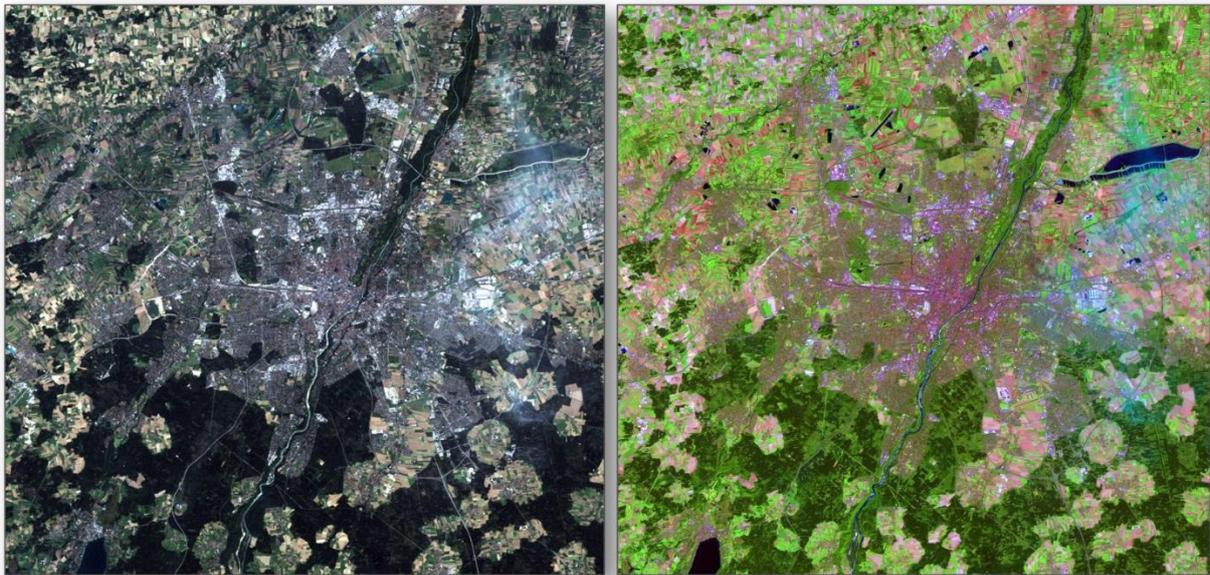
**Abbildung 6: Aufnahme des Satelliten Landsat 7 dargestellt in Echtfarben der drei Kanäle Rot-Grün-Blau (links) sowie als Falschfarbenkomposit der fünf Kanäle Rot-Grün-Blau-nahes Infrarot-mittleres Infrarot.**
