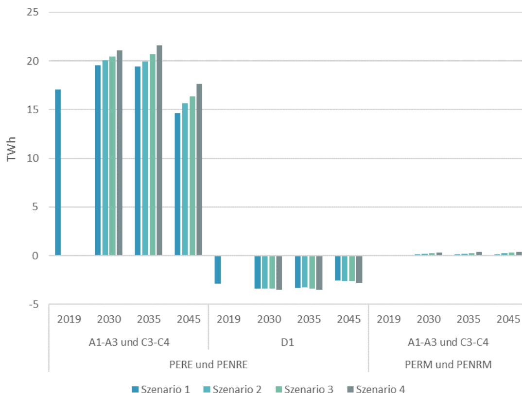
Abbildung 35: Primärenergieaufwand (energetisch und stofflich) der verschiedenen Szenarien im Dämmstoffmarkt über den gesamten Lebenszyklus
