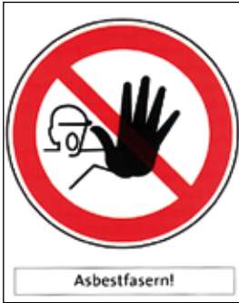
Asbestverbotsschild nach BGV A8: Zutritt für Unbefugte verboten
