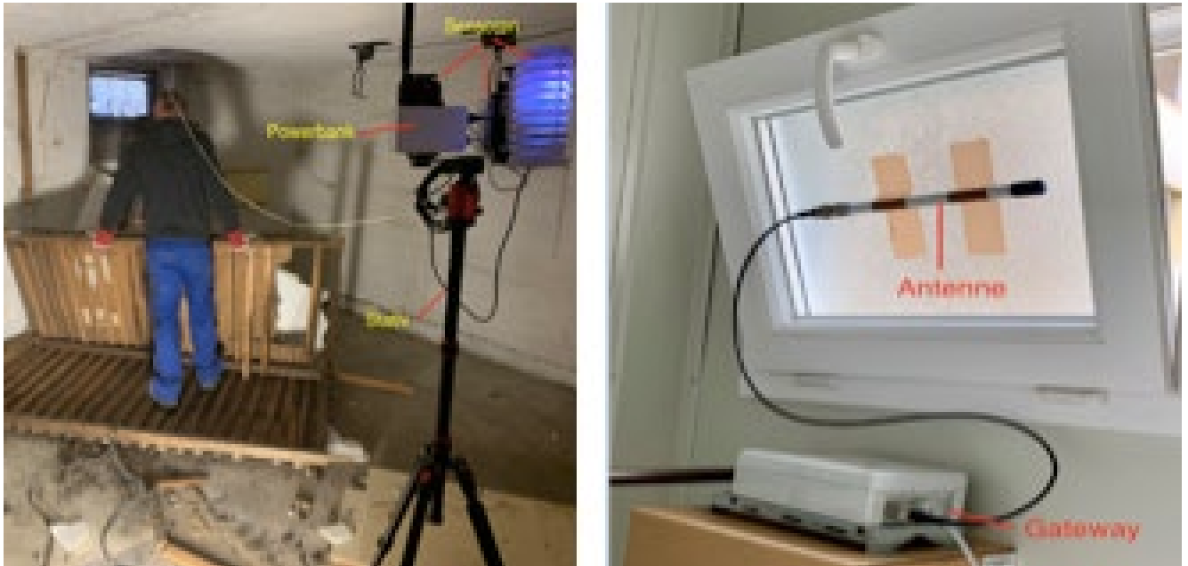
Abbildung 4: Messvorgang Umweltdaten (links) und Gateway mit Antenne (rechts)
