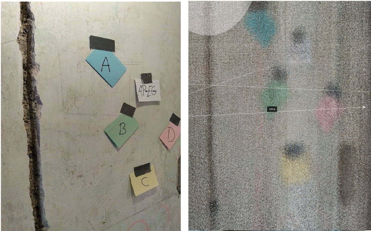
Abbildung 41: Ankerpunkte mittels farbiger Karteikarten: Foto (links) 86 und ReCap (rechts) 87
