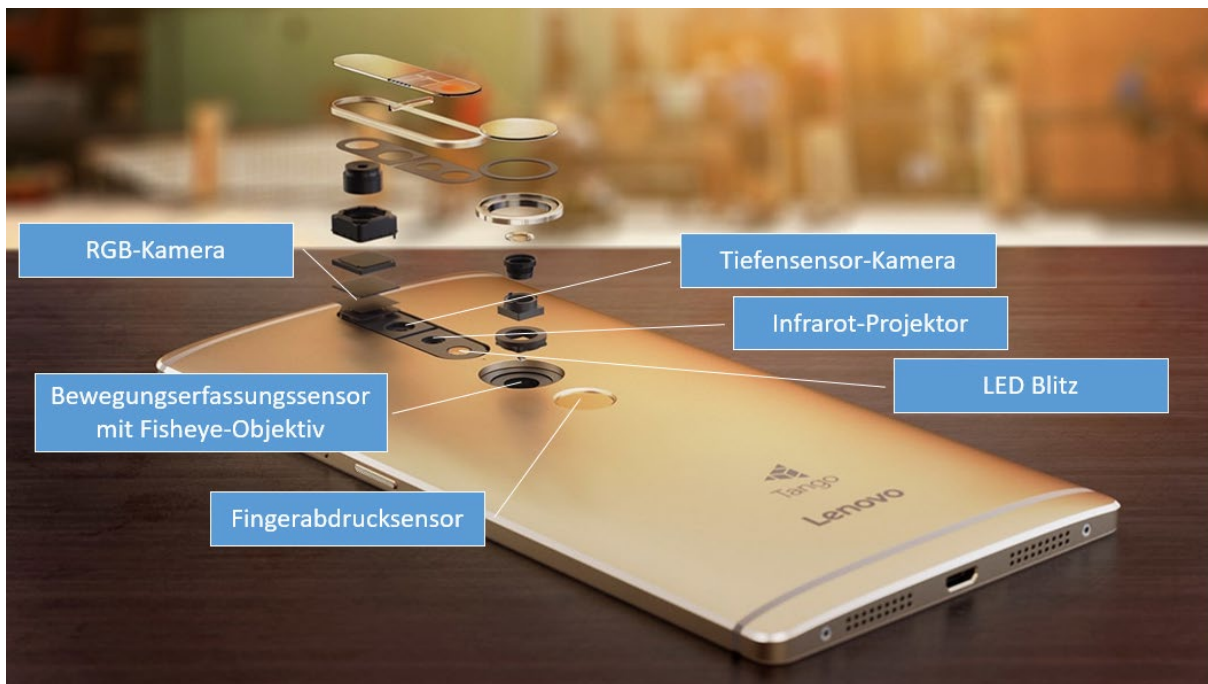
Abbildung 21: Rückseite Lenovo Phab 2 Pro mit Beschriftung der Sensoren 54
