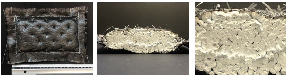
Bilder zu Versuchsreihe Ofenverfahren, (Textil A, Beads B mit HVP, einstufiger Prozess)
