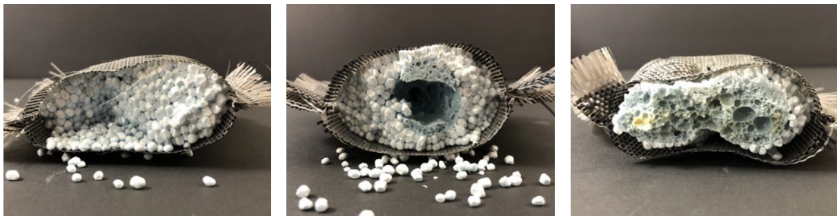
Bilder zu Versuchsreihe Mikrowelle (Textil B, Beads A, 800), links mit 3,5 Min, mitte 4 Min und rechts 4,5 Min / Textiltaschen 2 cm hoch)
