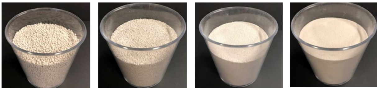
Blähglas in unterschiedlichen Körnungen: 2 – 4 mm, 1 – 2 mm, 0,5 – 1 mm und 0,25 – 0,5 mm
