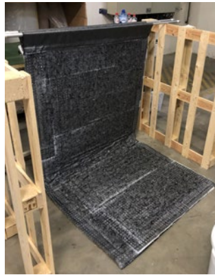
Aufhängung der 3D Textilien zur vertikalen Einfüllung der PET-Beads
