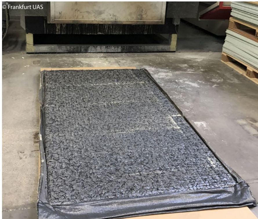
Auskühlen und Konsolidierung des Demonstrators (1 x 2m) nach 90 Min. im Ofen
