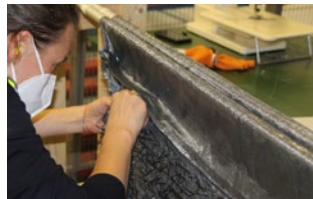
Aufhängung der 3D Textilien zur vertikalen Einfüllung der PET-Beads
