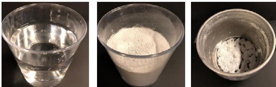
von links nach rechts: Geosil 14517, Stabilisil 40 und Slurry aus Geosil/Stabilisil
