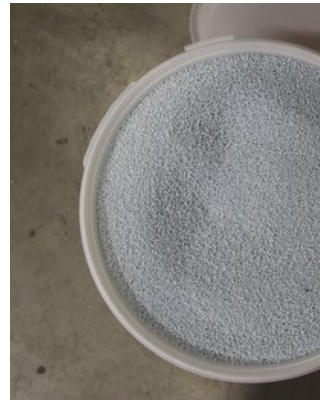
Rohmaterial PET- Beads mit polyesterbasierter thermoplastischer Beschichtung
