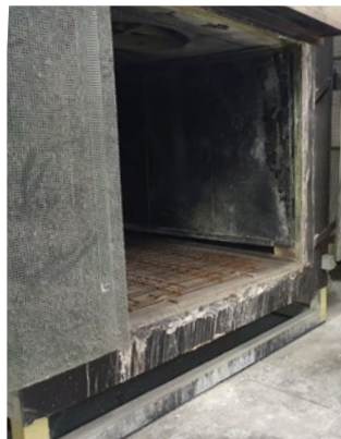
Vorgeheizter Ofen bei Armacell mit Bewehrungsmatten als Abstandshalter
