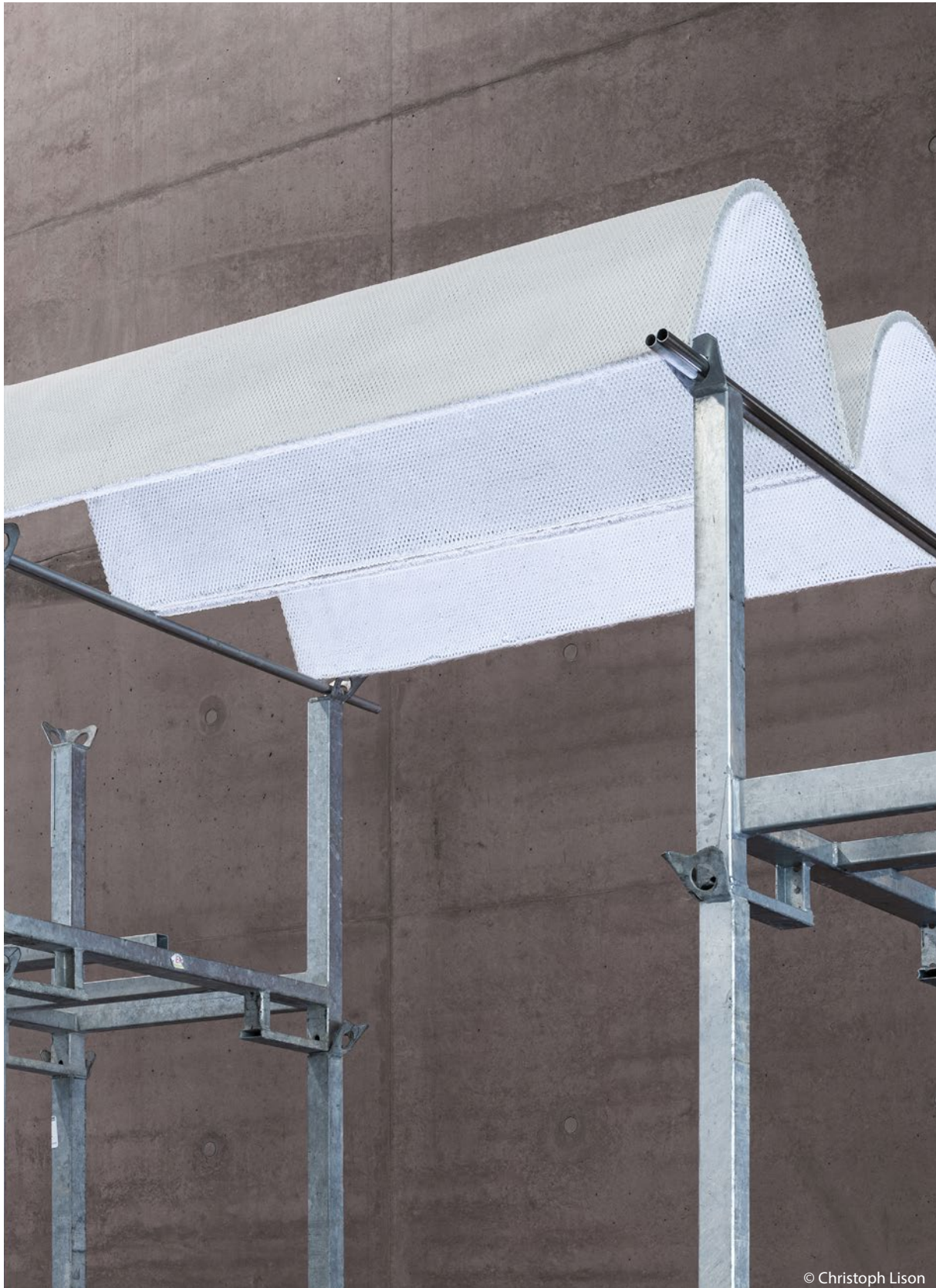
Demonstratorelement 200 cm *100 cm, Bläh-/Wasserglasmatrix, eingerakelt in ein PE Gewirke, einseitig gekrümmt, luftgetrocknet
