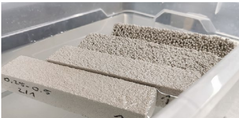
Probekörperzustand der Prismen nach fünfwöchiger Wasserlagerung in einem Wasserbad
