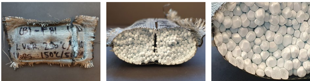
Bilder zu Versuchsreihe 3, Konvektionsofen, Textil B, Beads B ( im Textil vorgeschäumt und verschweißt), 45 Min.)
