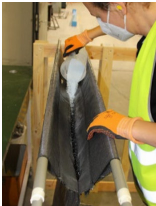
Befüllen der Textiltasche mit ArmaShape PET-Beads
