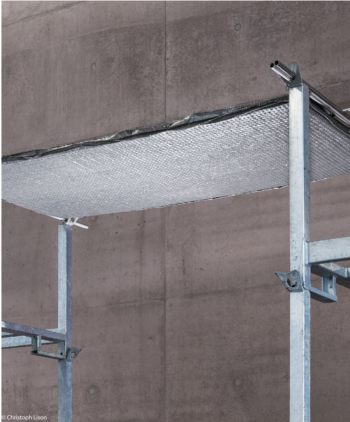
Finaler Demonstrator aus PET Textil und PET Schaum, Untersicht
