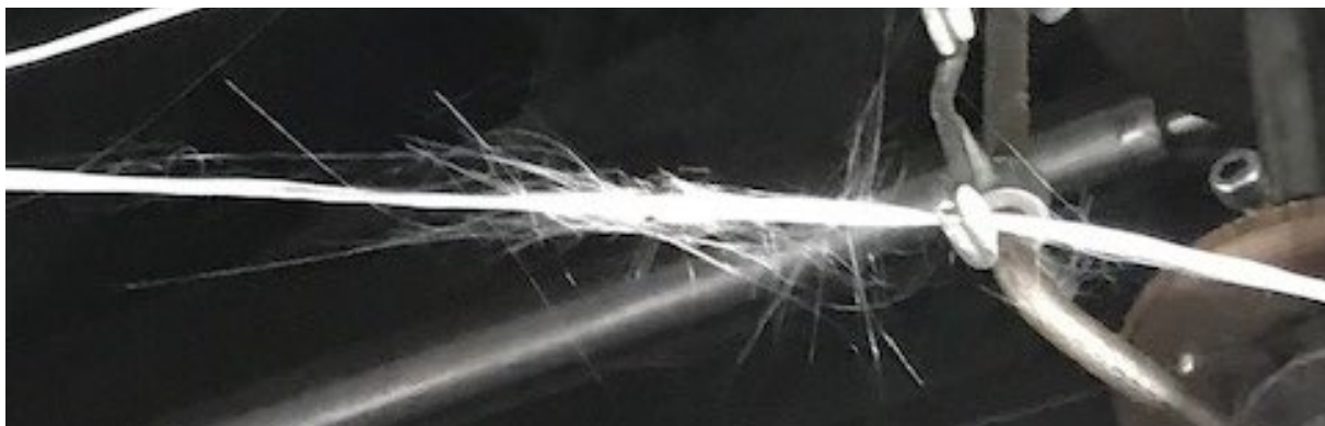
AR-Glasfaser, Auffasern am Einzug der Webmaschine
