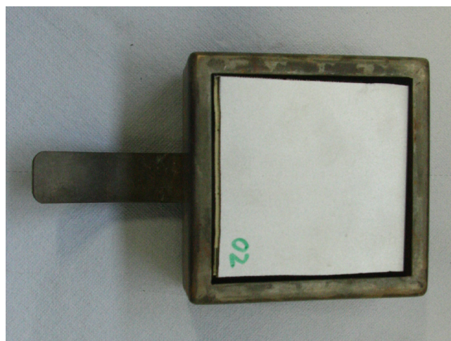
Abbildung 5-6: Cone-Kalorimeter-Probe des Laptops im Probenhalter
