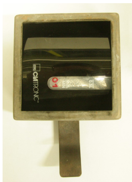
Abbildung 5-8: Ansicht eines Wasserkochers mit Sägekanten (li.), Cone-Kalorimeter-Probe des Wasserkochers im Probenhalter (re.)
