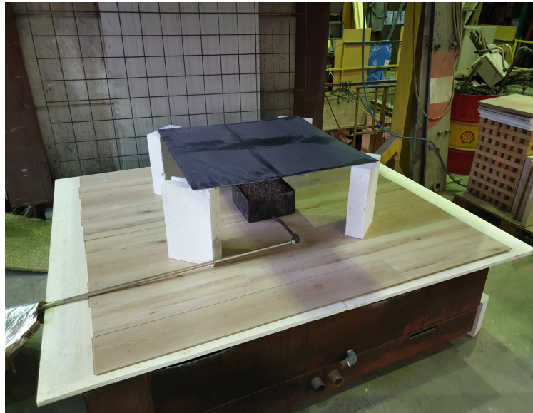
Abbildung 6-3: Versuchsaufbau zur Untersuchung der Bodenbeläge, hier Laminat, bei indirekter Beflammung mittels „Reflexionstisch“
