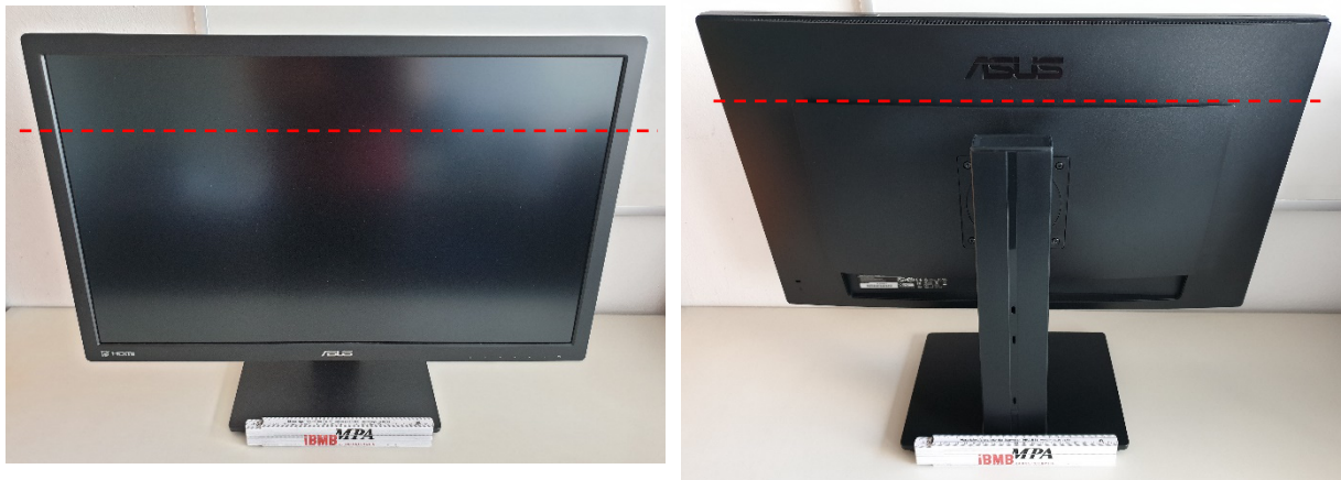
Abbildung 5-2: Vorder- und Rückseite des untersuchten Computerbildschirms, rote Sägekanten für die Probenherstellung
