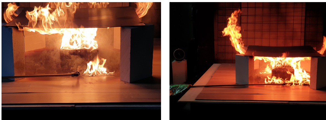
Abbildung 6-27: Ausbreitung der Flammen während des Laminat-Großversuches, 5 Sekunden (li.) und 5 Minuten (re.) nach Initialzündung
