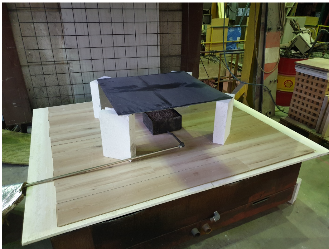
Abbildung 6-26: Versuchsaufbau des Großversuches mit dem Laminat bei indirekter Beflammung durch „Reflexionstisch“
