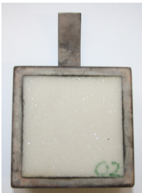
Abbildung 5-7: Cone-Kalorimeter-Probe der PUR-Matratze im Probenhalter
