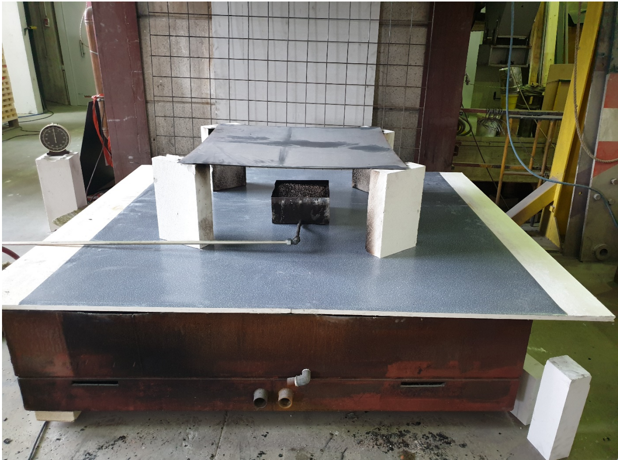
Abbildung 6-19: Versuchsaufbau des Großversuches mit dem PVC-Fußboden bei indirekter Beflammung durch „Reflexionstisch“
