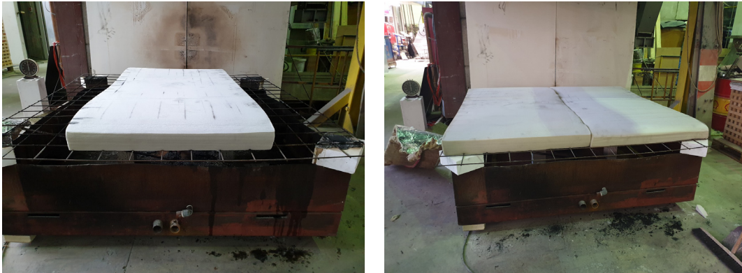
Abbildung 6-12: Versuchsanordnung des Großversuchs mit der Matratze in der Anordnung „Einzelbett“ (li.) und „Doppelbett“ (re.)
