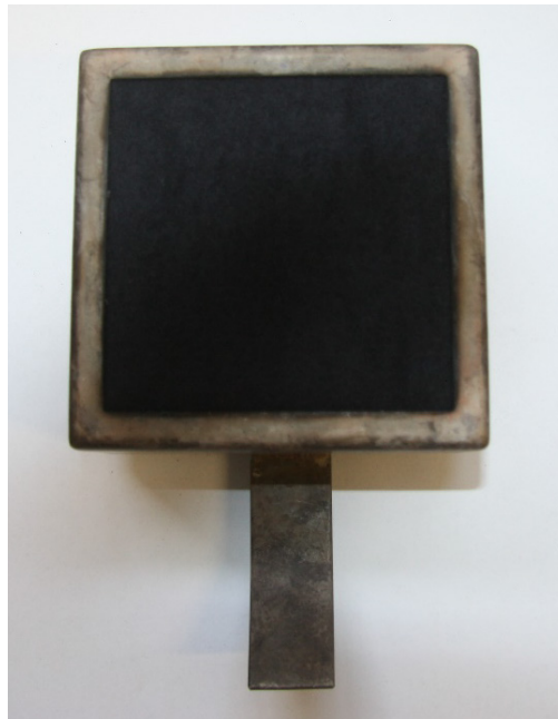
Abbildung 5-4: Dreilagige Cone-Kalorimeter-Probe der Kleidung im Probenhalter
