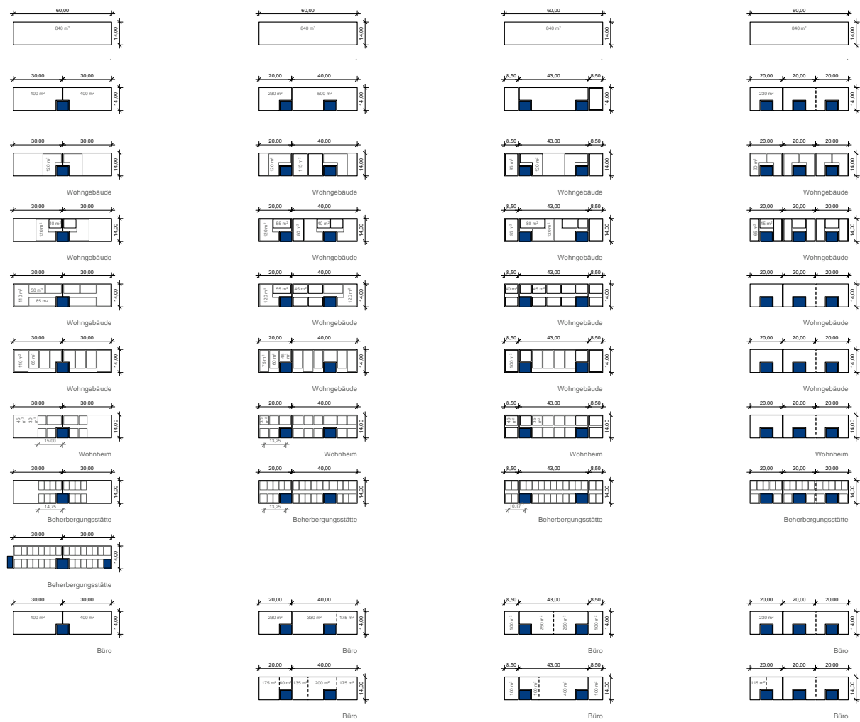
Abbildung 4-20: Gebäudestrukturelle Analyse für riegeelförmige Gebäude mit den Grundrissabmessungen 60 x 14 m (L x B) für die berücksichtigten Hauptnutzungsarten
