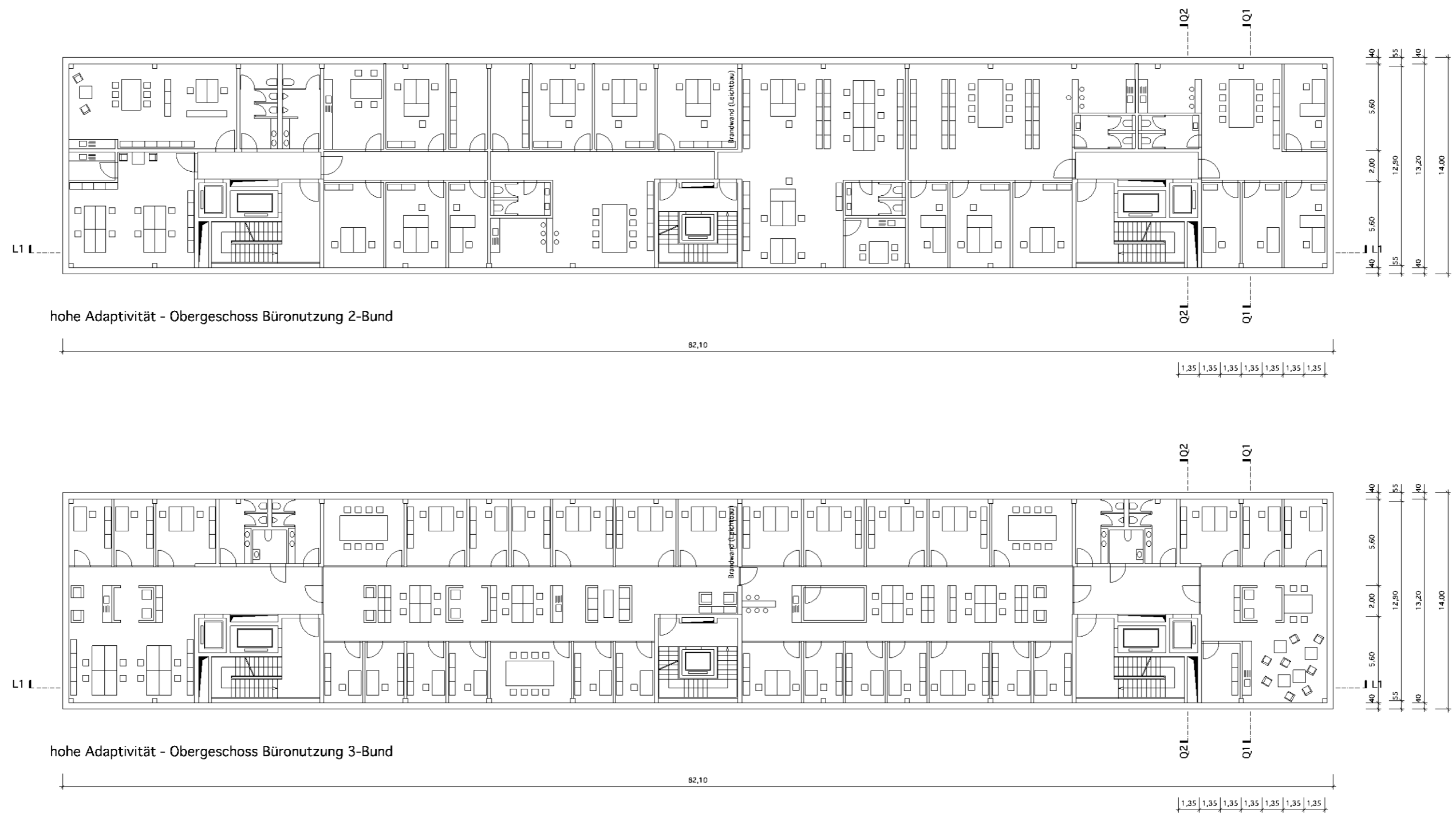
Abbildung B 23: Grundrisse Obergeschoss des Referenzgebäudes „hohe Adaptivität“ für eine Büronutzung im 2-Bund (oben) und im 3-Bund (unten)
