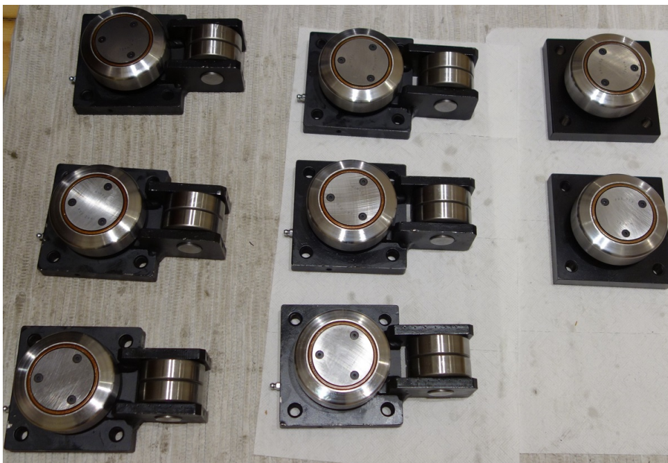
Abb. 5.8: Rollen nach Dichtungsmodifikation (Quelle: Wulf Wulff, BTU Cottbus - Senftenberg)
