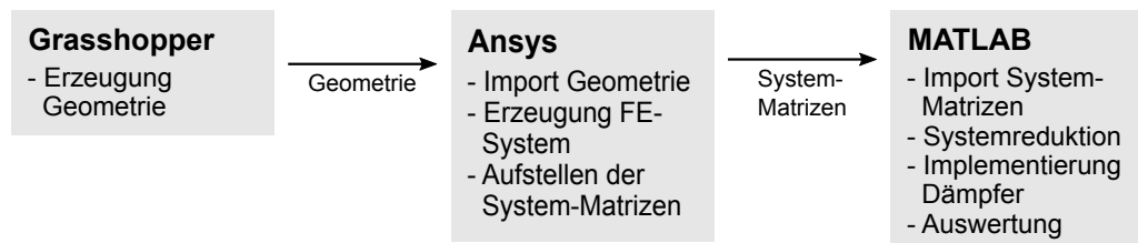
Abb. 2.2: Workflow der Modellbildung, bestehend aus Geometrieerzeugung, Aufstellen des Finite-Element-Modells und Modellreduktion
