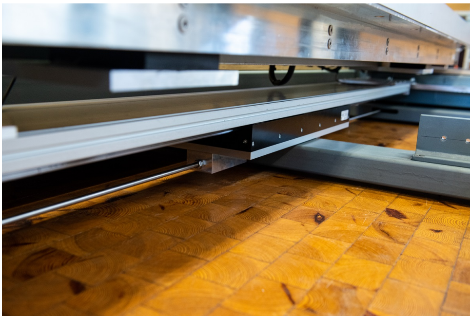
Abb. 5.13: Nilab-Antrieb eingebaut, Magnetschiene oben beweglich (Quelle: Ralf Schuster, BTU Cottbus - Senftenberg)
