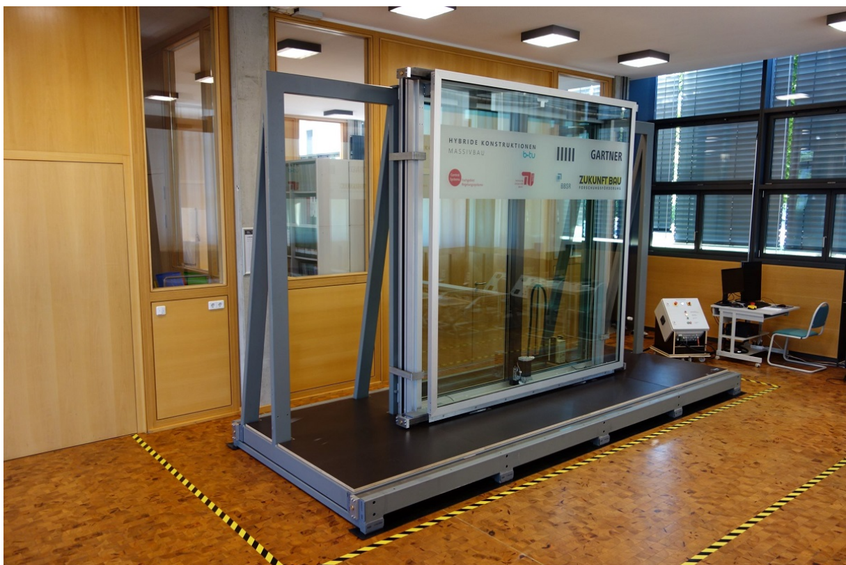
Abb. 5.2: Gesamtansicht der beweglichen Doppelfassade auf dem Prüfstand (Quelle: Ralf Schuster, BTU Cottbus - Senftenberg)
