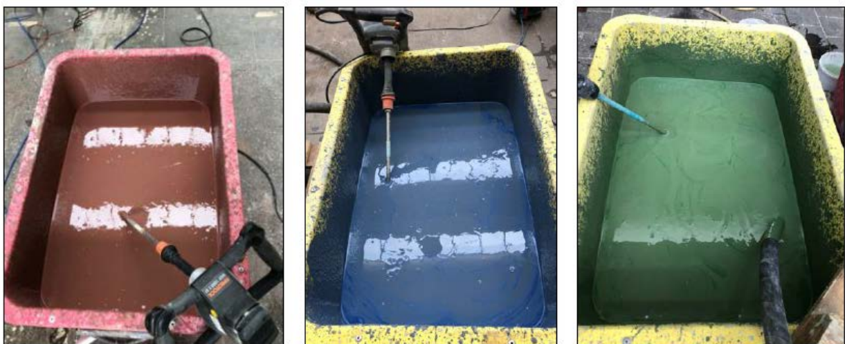
Abb. 4.5: Eingefärbte Suspensionen (1. Großversuch) (Mück-Thum, 2018)
