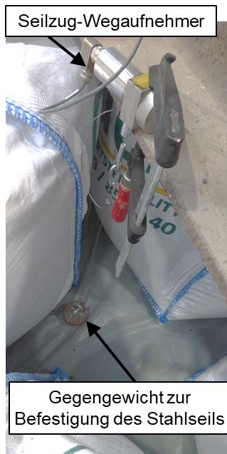
Abb. 4.7: Seilzug-Wegaufnehmer zur lokalen Verformungsmessung (1. Großversuch)
