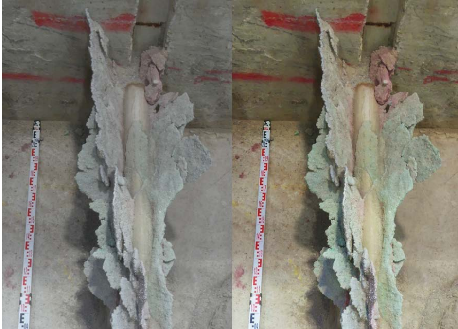
Abb. 4.15: Aufnahme der Injektionskörperstrukturen. Links die Originalaufnahme, rechts die Aufnahme nach der Bildbearbeitung (hier mittels PowerPoint: Schärfe +10 %, Helligkeit+5 %, Kontrast +15 %, Farbsättigung 130 %, Temperatur 7.500)
