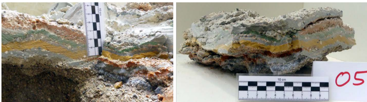
Abb. 4.51: links: Aufgetrennte horizontale Plattenstruktur (Rohr 1, 1h) rechts: Bruchstück einer horizontalen Plattenstruktur
