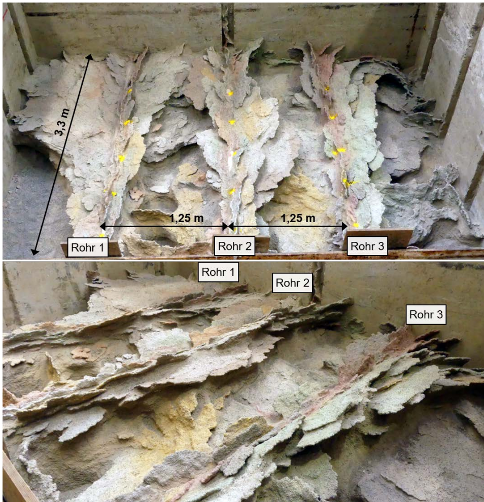
Abb. 4.45: Freigelegte Injektionskörper des 2. Großversuchs
