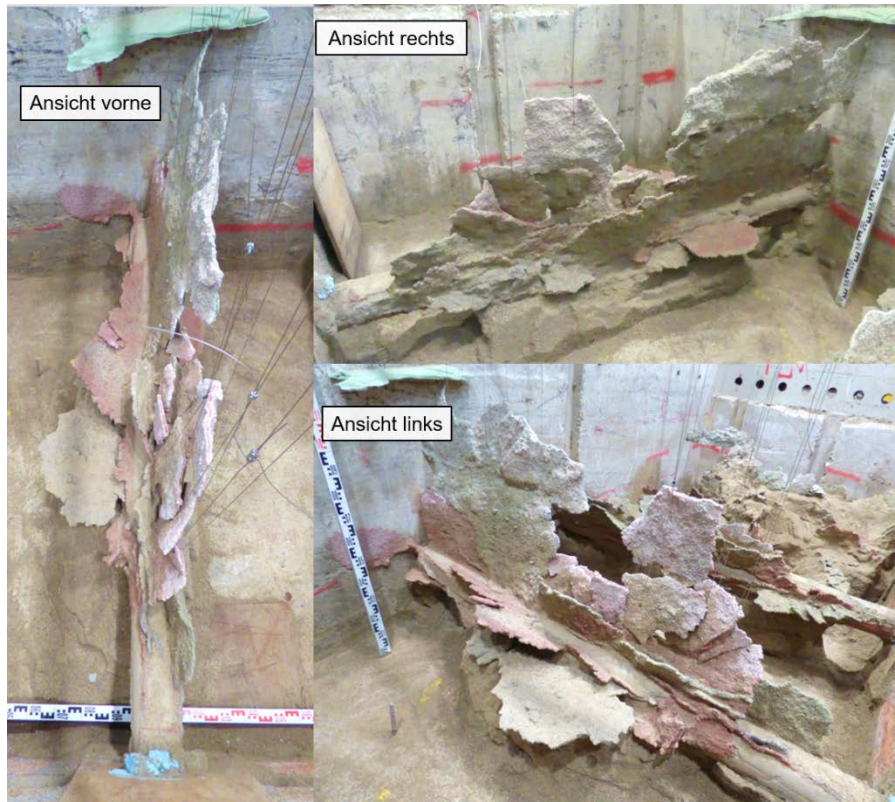
Abb. 4.25: Injektionskörper am Manschettenrohr 1
