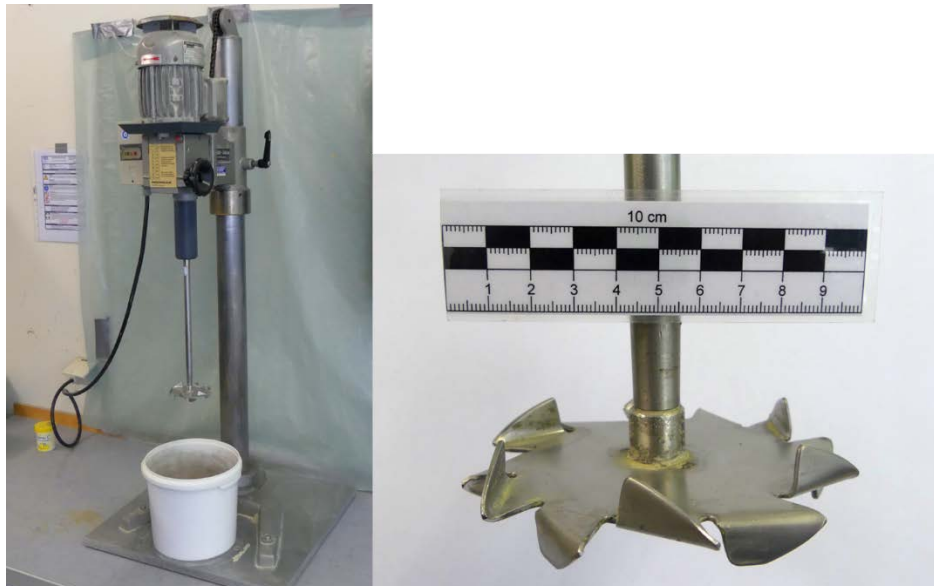
Abb. 2.3: links: Labormischer rechts: Zahnscheibenrührer
