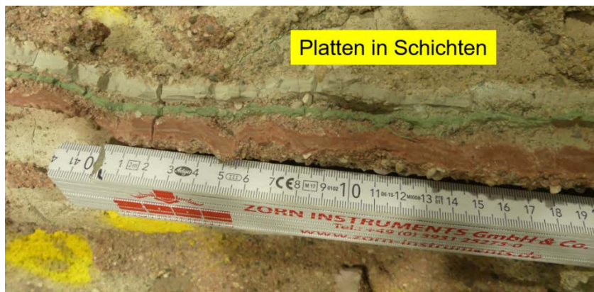
Abb. 4.36: Verbund aus mehreren Schichten an Injektionsrissen/ Plattenlagen
