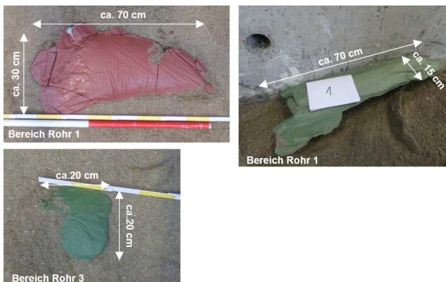
Abb. A 3: Detailansicht der Suspensionsaustritte an der Geländeoberfläche (1. Großversuch)
