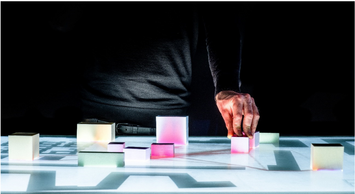
Abbildung 6 Parametereingabe durch intuitive Interaktionen mit physischen Objekten (Quelle: Lehrstuhl für Architekturinformatik)
