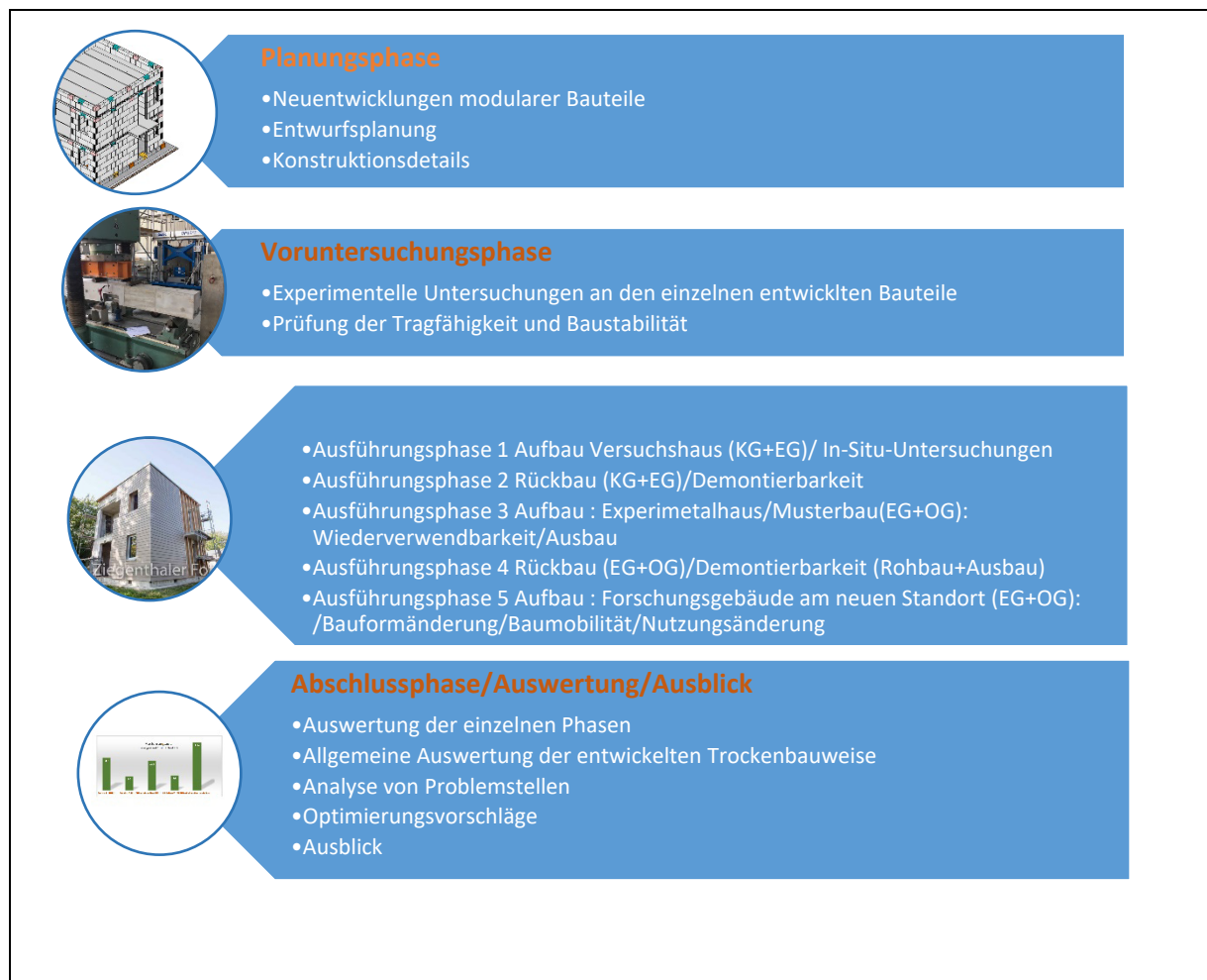
Bild 336 Vorgehensweise bei der Entwicklung der praktischen Anwendbarkeit der Trockenbauweise
