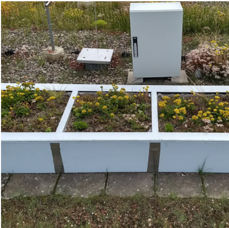
Abb. 48: Wiegende Kleinlysimeter zur Bemessung der ET a .
