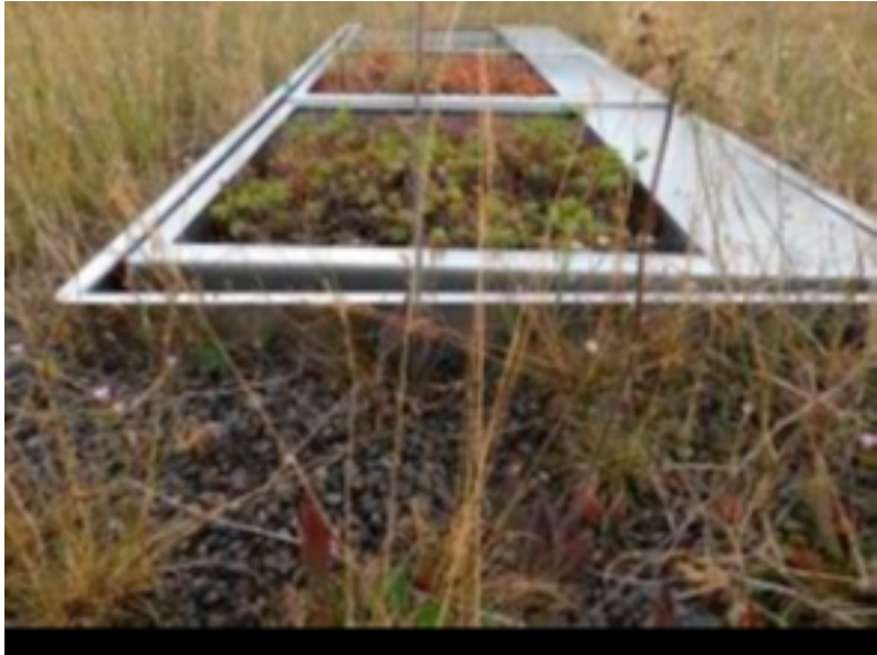
Abb. 10: Integration der wiegenden Lysimeter in ein bestehendes Gründach, Hochschule Neubrandenburg (Haus 3).
