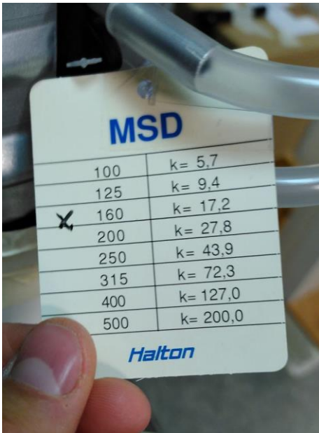
Abbildung 71: k-Wert des Druckmesskreuzes in Abhängigkeit der Rohrnennweite [PHI]
