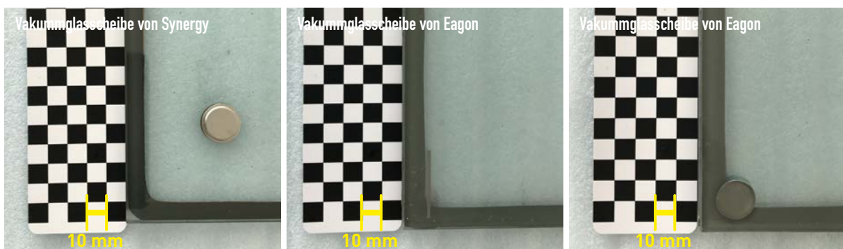
Abbildung 2 VG - Detail einer Scheibe, Links: Abstandshalter, Getter und Evakuierungsventil unter Abdeckkappe, Synergy. Mitte: Getter in der Eagon VG-Scheibe, Rechts: Evakuierungsventil, Flächenbündig an der Eagon VG-Scheibe
