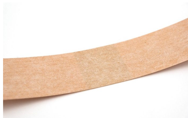
Abb. 5 Unterseite des Holzfurniers mit Vlieskaschierung
