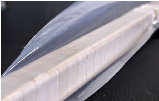
Abb. 37 Verpresstes Rechteckhohlprofil im Vakuumsack
