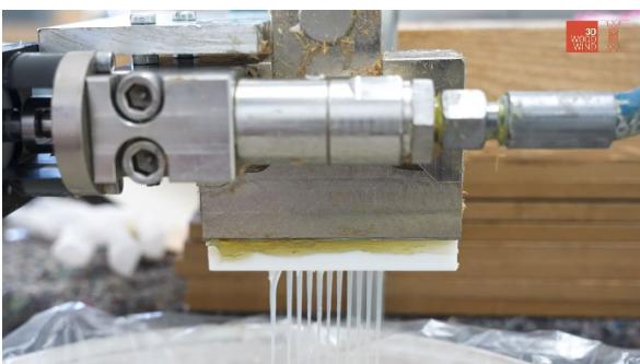
Abb. 92 Automatisierte Klebstoffapplikation mittels Auftragskopf
