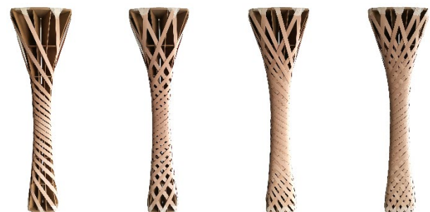
Abb. 63 Lagenaufbau der Stützen am 1:2 Modell
