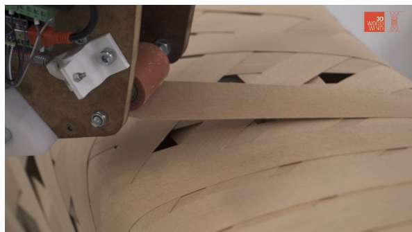
Abb. 103 Kreuzweise gewickelte Lage gegen den Uhrzeigersinn
