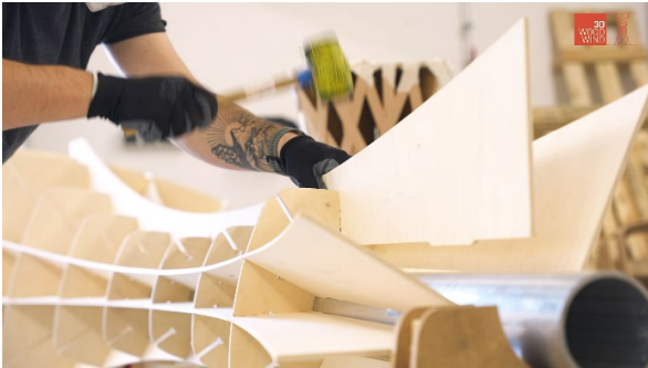
Abb. 97 Zusammenbau des Schalungselements für die Stützenbauteile
