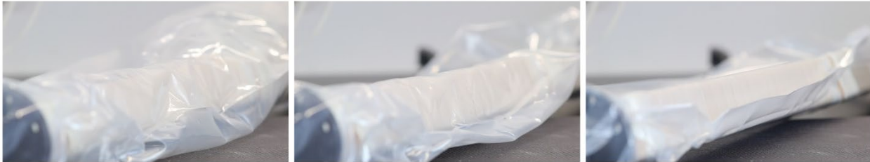
Abb. 36 Nachträgliches Verpressen mittels Vakuum
