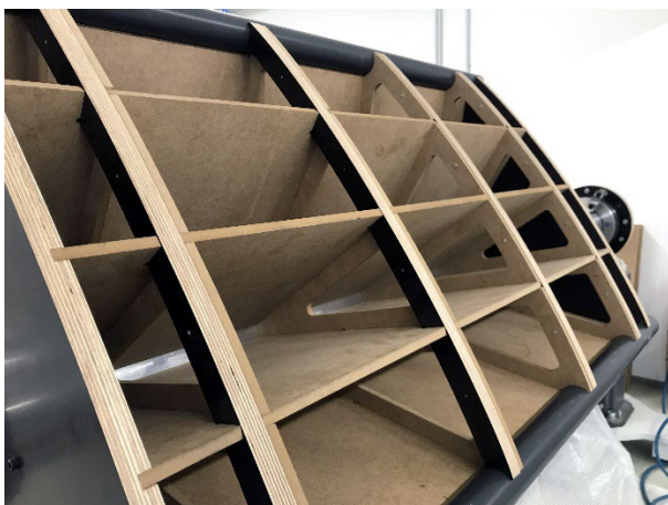
Abb. 57 Innere Struktur der Schalung
