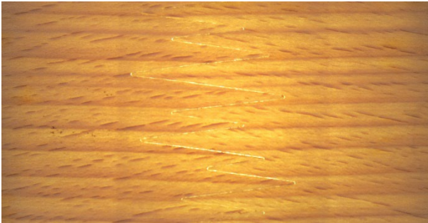
Abb. 6 Detailaufnahme Keilzinkenverbindung zweier Furnierstreifen
