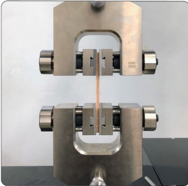
Abb. 11 Zugversuch der Probekörper
