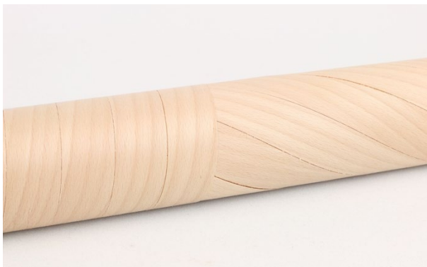
Abb. 22 Rundhohlprofil mit abwechselnd 1 / 6 Furnierbändern
