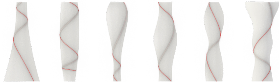
Abb. 24 Generierung von Wickellinien an unterschiedlichen Freiformen
