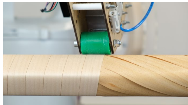
Abb. 33 Aufwölben des Furniers bei steilen Wickelwinkeln
