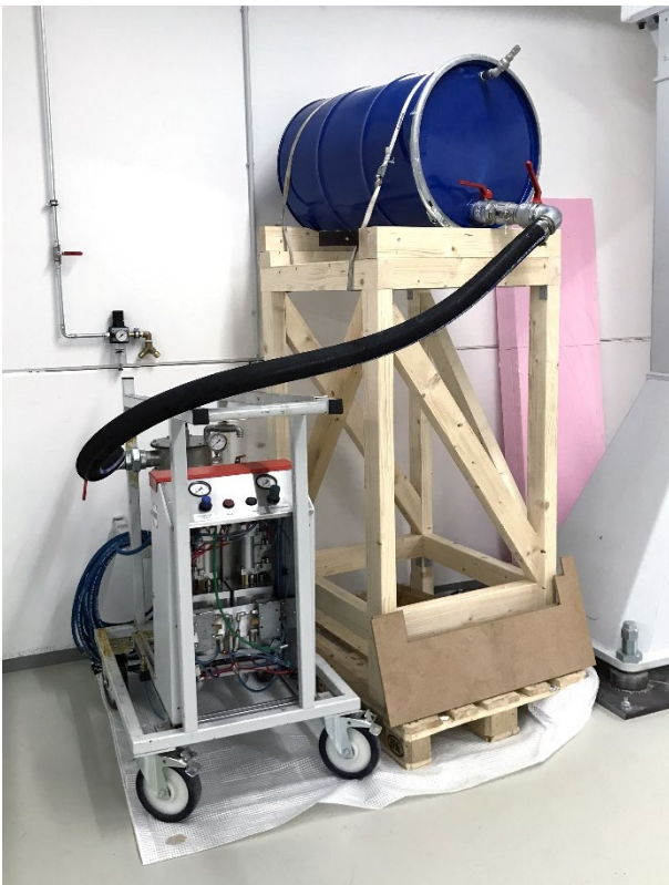
Abb. 69 Dosieranlage HYDROTOP 1D150M mit Klebstofffass
