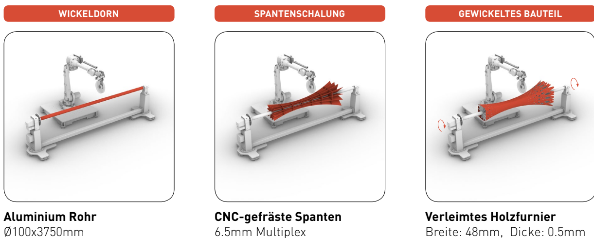
Abb. 61 Schalungssystem der Stützelemente
