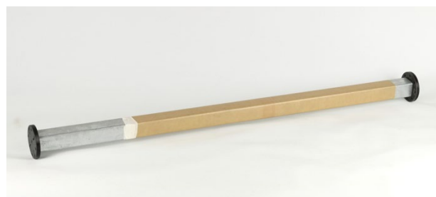
Abb. 42 Rechteckiger Stahldorn mit einer Trennschicht aus Backpapier
