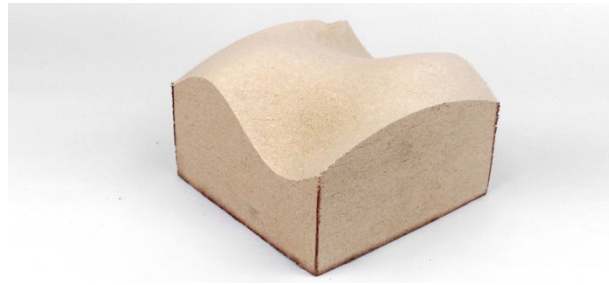
Abb. 44 Subtraktiv geformte Freiformschalung
