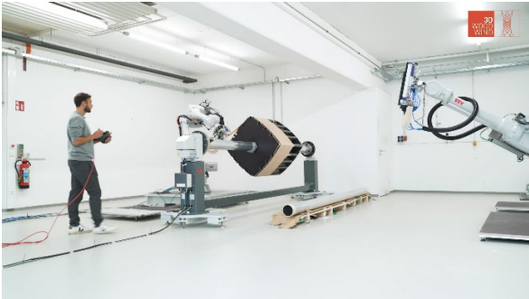
Abb. 89 Roboteranlage mit Schalungselement der Deckenmodule
