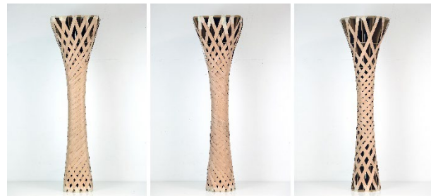
Abb. 62 Variierende Querschnittsgeometrien der Stützenbauteile
