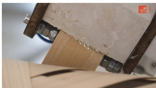
Abb. 96 Verleimung des Furniers von der Unterseite
