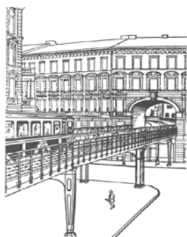
Abbildung 8: Überbauung eines Hochbahnviadukts 19
