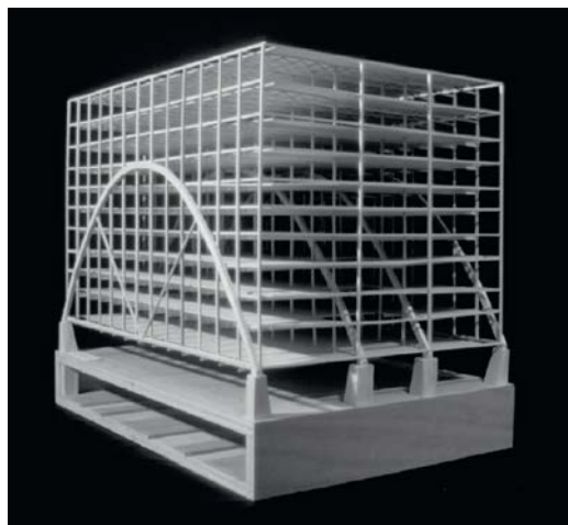
Abbildung 37: Broadgate Exchange House – Tragwerksmodell 145
