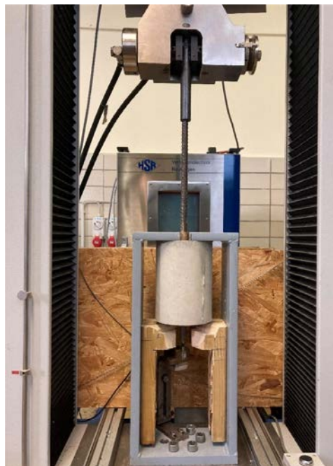
Abbildung 29: Probekörper mit Bewehrungsstahl während der Ausziehversuche
