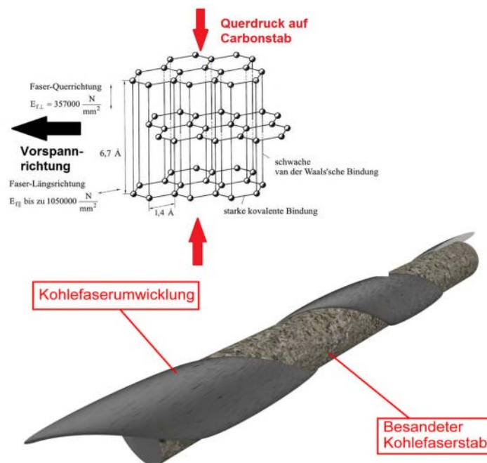
Abbildung 16: Berücksichtigung der materiellen Eigenschaften des Kohlefaserstabes
