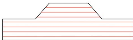
Abbildung 57: Faserorientierungen in der Profilierung der gefrästen GFK-Stäbe
