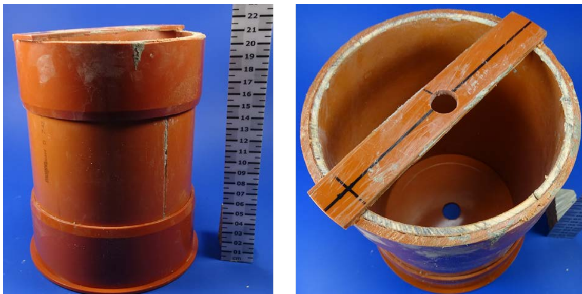
Abbildung 27: Als Schalung für die Herstellung der Betonprobekörper verwendete Kanalgrundrohre und aufgesetzte Muffenstopfen
