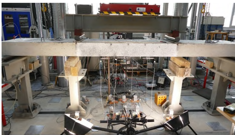
Abbildung 102: Versuchsaufbau der Übergreifungsversuche
