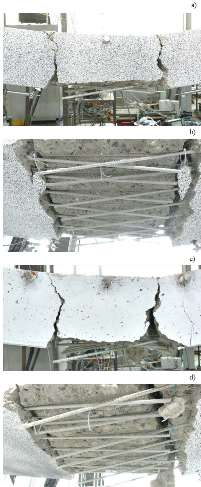
Abbildung 106: Versagen der Versuchskörper SL-400 unter Biegung: a) und b): SL-400 (1), c) und d): SL-400 (2)
