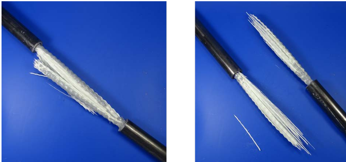
Abbildung 26: Bruchbild der bis zum Versagen gezogenen Glasfaserstäbe
