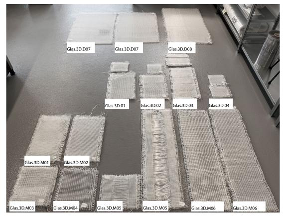
Abbildung 134, Übersicht Bestand kettengewirkte Abstandstextilen für Prüfungen und Demonstratoren
