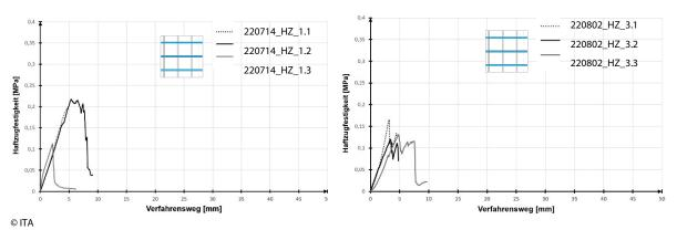
Eine Erklärung für die geringere Haftzugfestigkeit beim Druck auf die Stehfadenseiten des Textils ist, dass die Druckoberfläche der Stehfäden geringer ist, die Stehfäden zudem verrutschen und sie im Gegensatz zu den Schussfäden nicht homogen verteilt sind.
