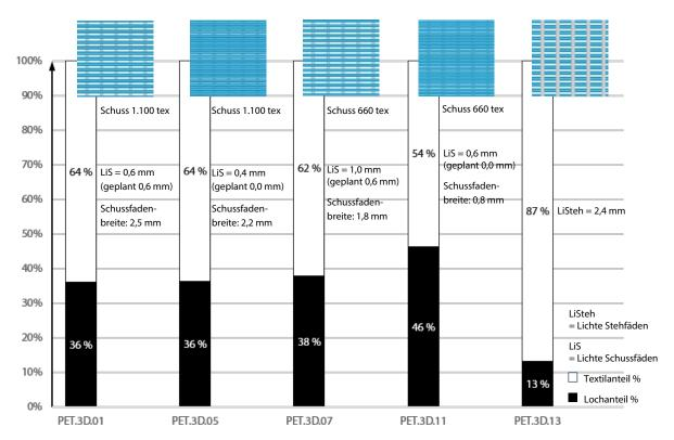
Abbildung 88, Analyse des Porenanteils der Oberflächen der kettengewirkten Abstandsgelege, fotographisch-digitales Verfahren im Vergleich zu manueller Auswertung
