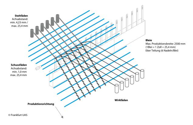
Abbildung 14, Oberflächenstrukturen kettengewirkter Biaxialgelege aus PES-Rovings, oben: Axonometrie, unten: jeweils Schnitte, links: dichte Variante, Schussfäden 2.200 tex, Stehfäden 2.200 tex; rechts: weiteste Variante Schussfäden 220 tex, Stehfäden 1.100 tex, Düsendurchmesser Druckmaterial = 0,4 mm; jeweils darunter ein Schnitt durch die Ebenen der Steh- und Schussfäden
