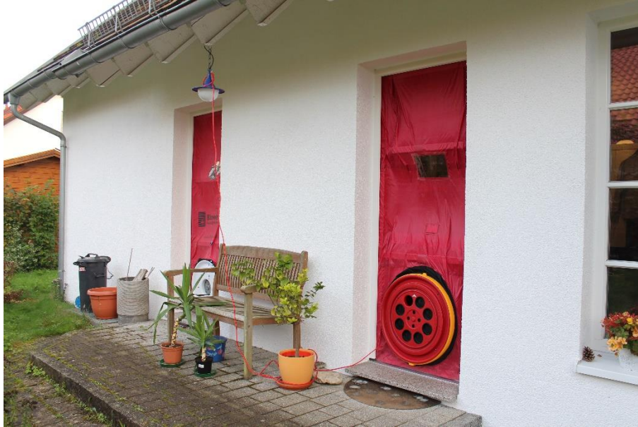
Abbildung 28 Minneapolis Blower Door Model 4.1 (links) und Retrotec 3000 SR (rechts) auf der Nordseite des Hauses
