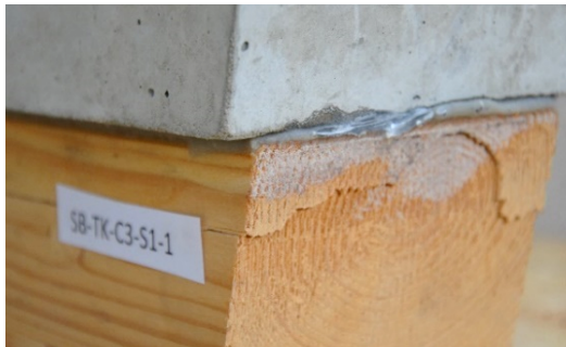
Abbildung 23 Typisches Versagensbild bei Holzversagen ( SF_t > 80\% | AF < 10\% )
