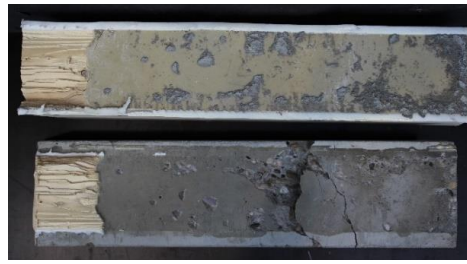
Abbildung 27 Typisches Versagensbild bei vorwiegendem Adhäsionsversagen (AF &gt; 50)
