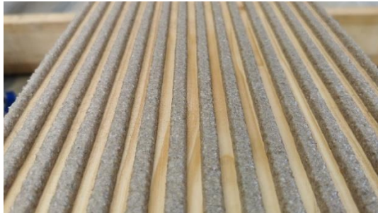
Abbildung 46 Auftrag des Klebstoffs E3 für die Trockenklebung (Serie B-TK-E3-FG)
