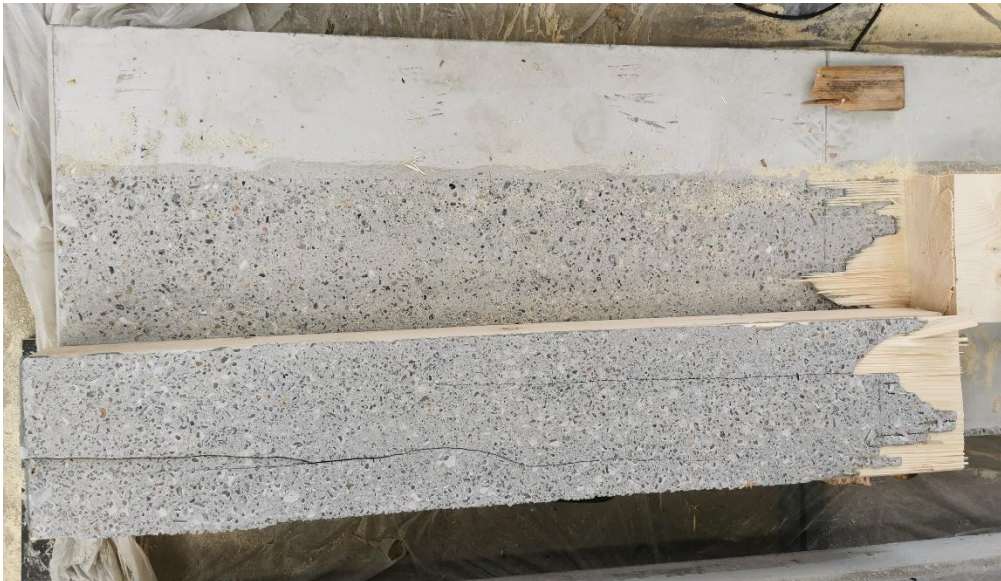
Abbildung 70 Mittels Spaltkeilen aufgetrennter Probekörper, der knapp oberhalb der Fuge im Beton getrennt wurde
