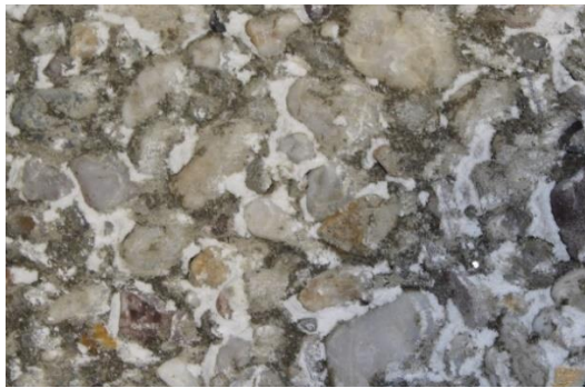
Abbildung 40 Weiße Ausblühungen an mit C3 nassgeklebten Probekörpern
