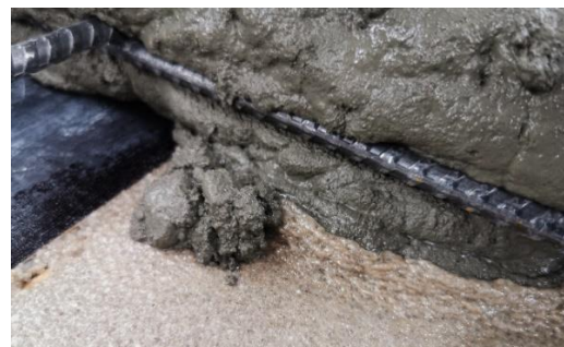
Abbildung 45 Verschieben des Klebstoffs durch den Beton bei den Probekörpern der Serie B-NK-E3
