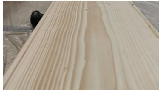
Abbildung 47 Vertiefungen in den Balken für den flächigen Auftrag des Klebstoffs für die Nassklebung (B-NK-E3)
