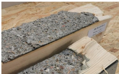
Abbildung 25 Typisches Versagensbild bei vorwiegend Betonversagen ( SF_c > 80\% | AF < 10\% )
