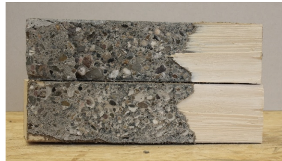
Abbildung 24 Gemischtes Versagen mit Anteilen von Holz- und Beton ( SF_t > 20-80\% | SF_c > 20-80\% | AF < 10\% )
