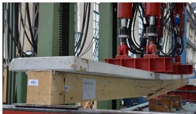
Abbildung 51 Biegeversuchskörper nach Biegezugversagen des Holzes
