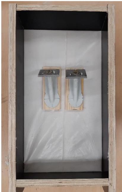
Abbildung 11 Scherversuchskörper mit FT-Verbindern von Würth vor der Betonage
