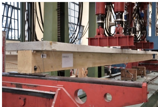
Abbildung 50 Biegeversuchskörper in der Prüfeinrichtung
