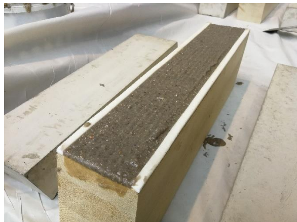
Abbildung 22 Herstellung von Probekörpern für die Scherversuche mit dem Klebstoff C1
