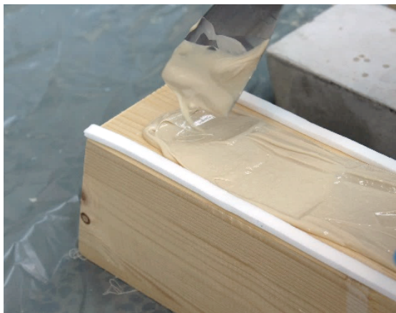
Abbildung 21 Auftrag des PU Klebstoffs auf das Holz mit Schaumstoffband gegen Ablaufen des Klebstoffs und als Abstandshalter
