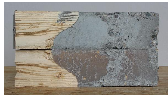
Abbildung 26 Gemischtes Versagen mit Anteilen von Holz-, Beton- und adhäsivem Versagen ( SF_t < 90\% | SF_c < 90\% | AF 10-50\% )
