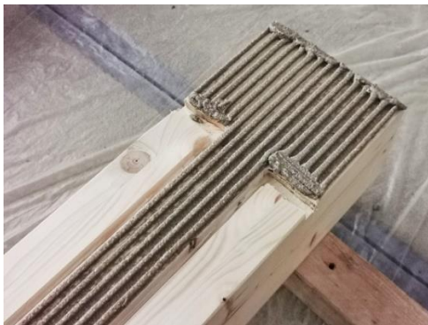
Abbildung 32 Holz balken mit Klebstoff vor Auflegen des Betonfertigteils (hier Prüfserie SBB-TK-E3-FG)
