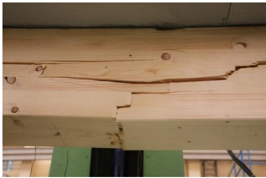
Abbildung 52 Typisches Versagensbild der Biegeversuchskörper: Biegezugversagen ausgehend von einer Keilzinkenverbindung an der untersten Lamelle
