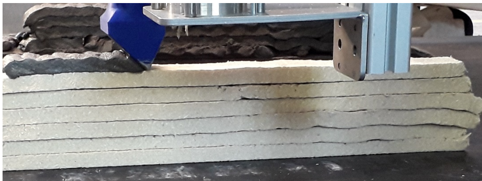
Abbildung 77: Ablage eines Betonfilaments auf die Stützstruktur, Rezeptur M-3.
