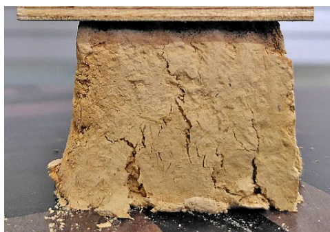
Abbildung 33: Bruchbild eines Druckversagens.
