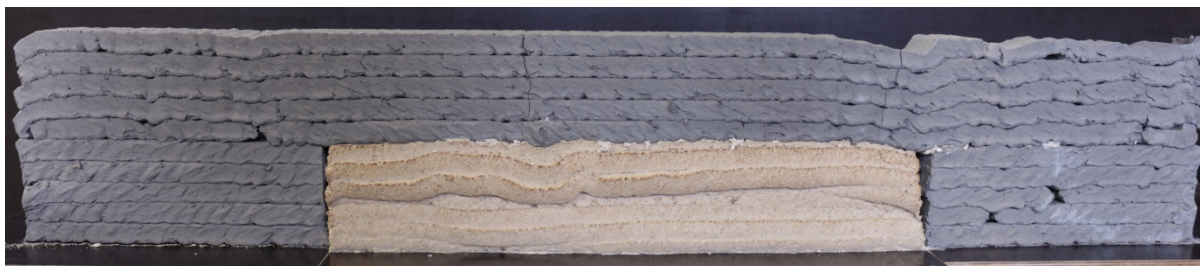
Abbildung 85: Fertige Demonstratorstruktur: Mittig unten Stützmaterial (Rezeptur M-25), links und rechts anschließend separat 3D-gedruckte Betonwandabschnitte, sowie kontinuierlich darüber gedruckter, durchgehender Beton.
