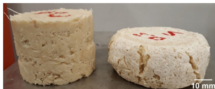
Abbildung 55: Probekörper des Stützmaterials: links vor der Prüfung, rechts nach der Prüfung.
