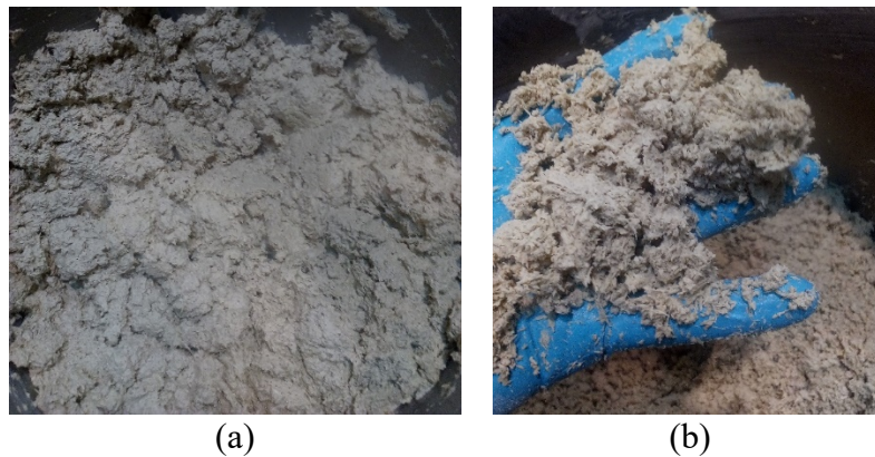
Abbildung 66: Konsistenz der Stützmaterialrezeptur M-4-Ref (a) vor dem ersten Rezyklierungszyklus, (b) nach dem ersten Rezyklierungszyklus.
