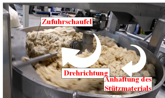
Abbildung 44: Erschwerte Zufuhr durch Anhaftung des Stützmaterials an den Zufuhrschaufeln des Extruders. Die weißen Pfeile stellen die Drehrichtung der Extruderschnecke bzw. der Zufuhreinheit dar sowie die durch die Anhaftung verursachte Rotation des Stützmaterials.
