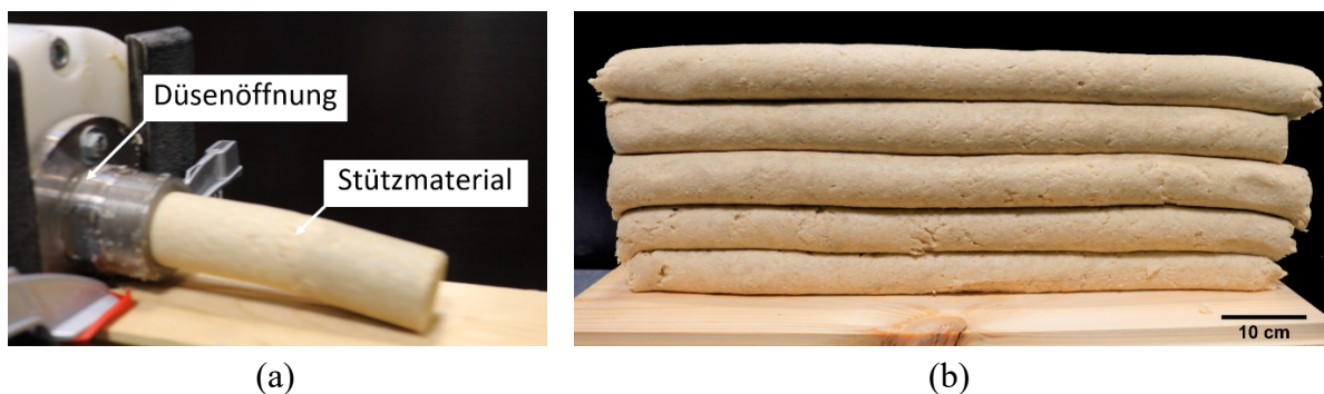
Abbildung 40: Mit dem Kolbenextruder hergestellte Stützstruktur aus dem Holz-Stärke-Komposit der Rezeptur M-1: (a) Extrusionsvorgang des Materials, (b) Probekörper aus dem Strängen.
