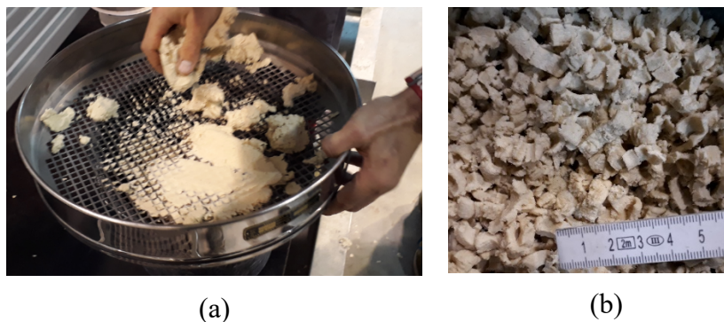
Abbildung 45: Granulierung des Stützmaterials für die Gewährleistung einer ungehinderten Materialzufuhr: (a) Verwendete Siebe für die manuelle Granulierung des Stützmaterials, (b) granuliertes Stützmaterial.
