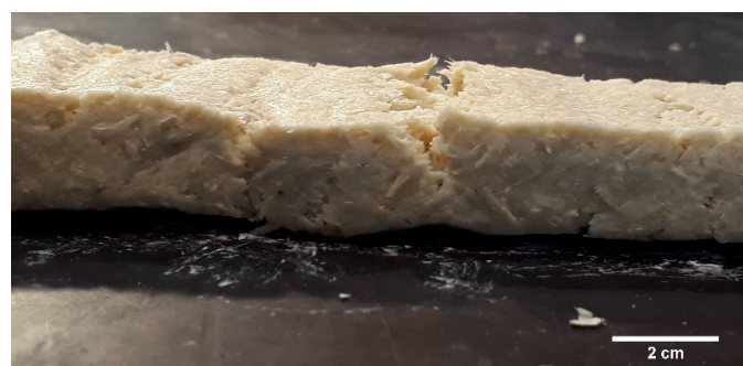
Abbildung 22: Diskontinuitäten im Querschnitt des 3D-gedruckten Stützmaterialfilaments.
