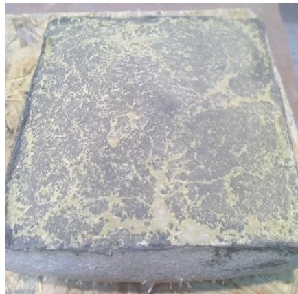
Abbildung 80: Grenzfläche des Stützmaterials nach dem Entfernen des Betons nach 24 Stunden Lagerung.
