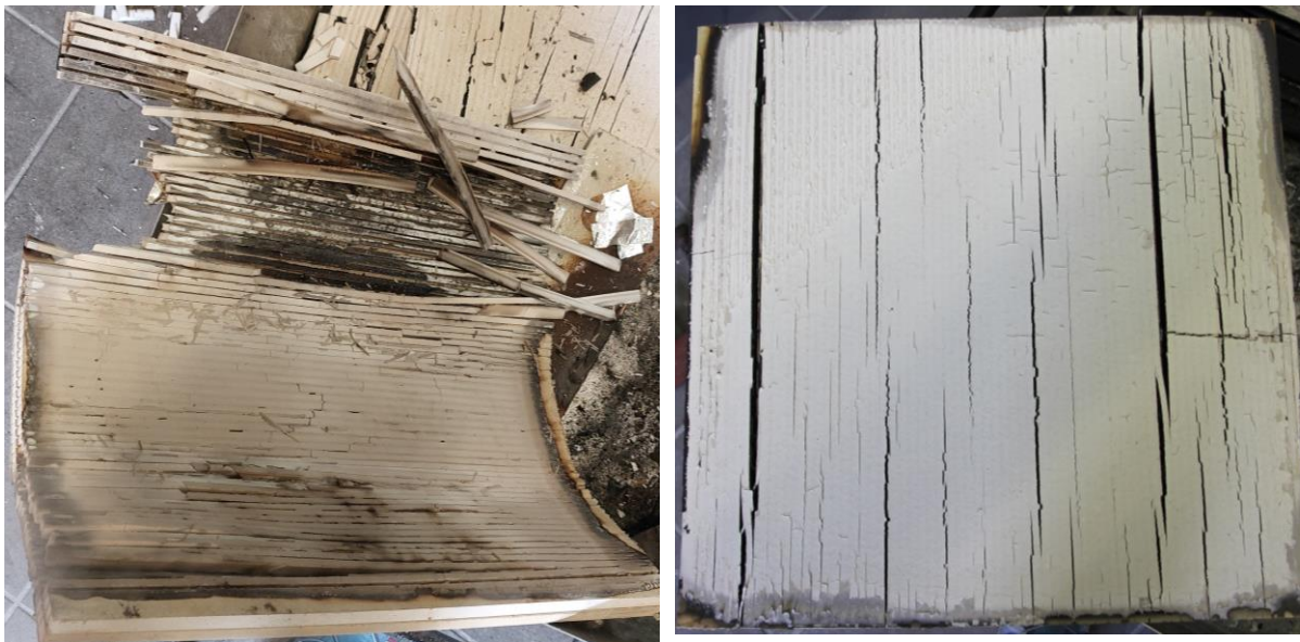
Abbildung 29: Probekörper nach der Feuerwiderstandsprüfung für die gefüllte (rechts) und ungefüllte (links) geschlitzte Gipskartonplatte.
