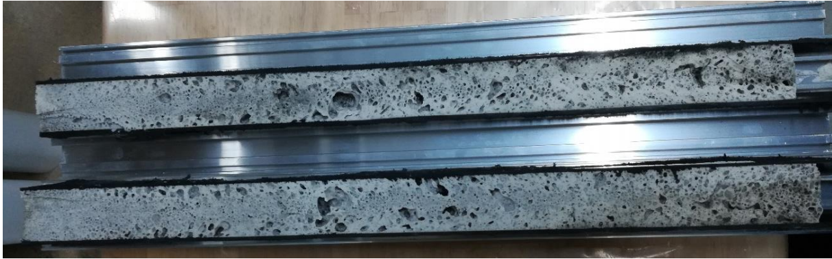
Abbildung 25: Schnitt und Aufsicht auf das ausgeschäumte Aluminiumprofil.
