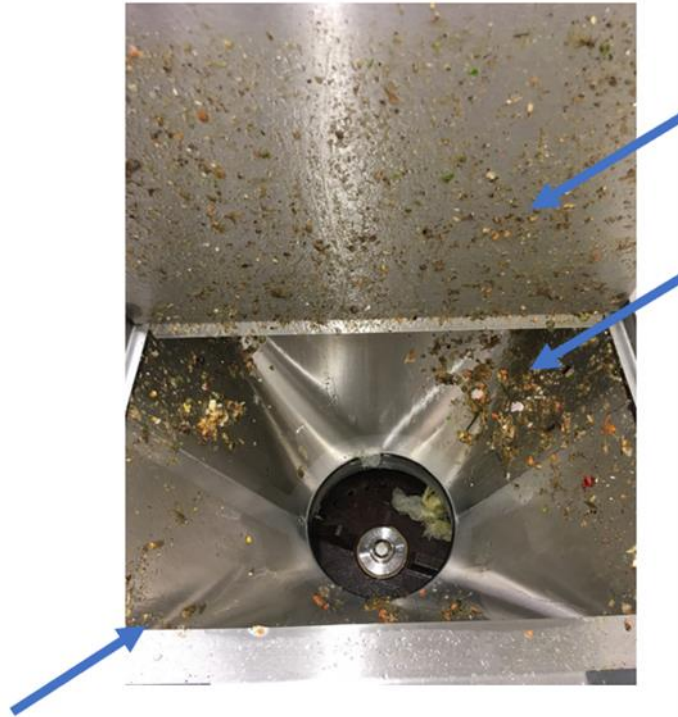
Abbildung 44 Verschmutzter Trichter nach einer Zerkleinerung
