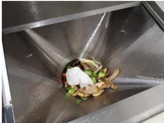
Abbildung 42 Trichter des Mazerator nach einem Zerkleinerungsvorgang
