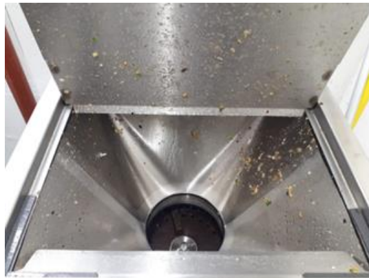
Abbildung 42 Trichter des Mazerator nach einem Zerkleinerungsvorgang
