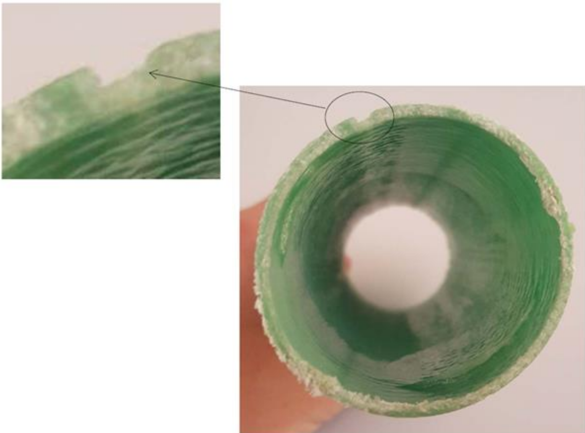
Abbildung 15 Kerbe (Nahtstelle) längs des Rohres
