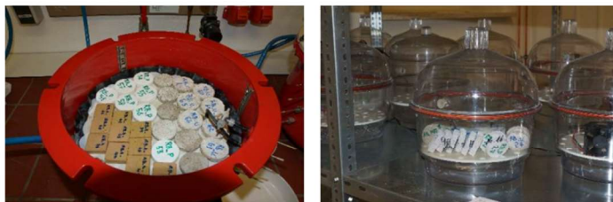
Bild 1 Druckplattenapparatur (geöffnet) und Exsikkator zur Wassergehaltsmessung
