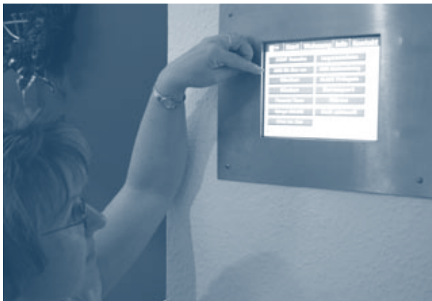
Druckempfindlicher Bildschirm zur Haussteuerung in Henningsdorf.
