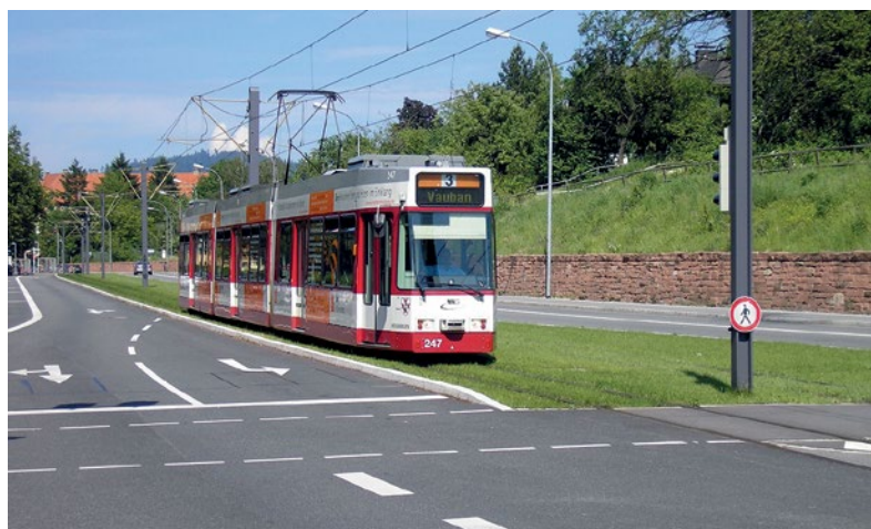
Eigener Gleiskörper als Rasengleis – die Musterlösung bei Verfügbarkeit der Flächen
