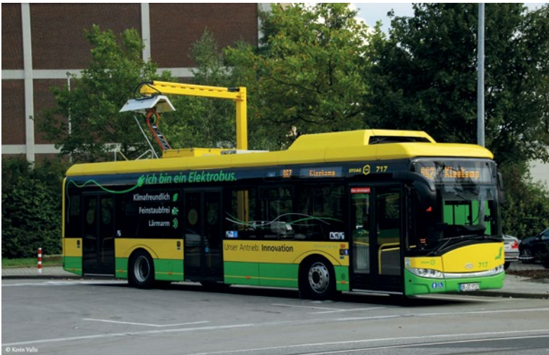
Elektrobus beim Ladungsvorgang. Mit einem Pantographen wird der Kontakt zur Ladestation hergestellt und der unter 10 Minuten dauernde Ladevorgang durchgeführt.
