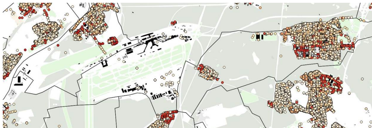
Abbildung 21: Gebäude als Punktinformation im Energiekonzept vom Regionalverband FrankfurtRheinMain. Die Objektinformationen wie Energienachfrage können farbcodiert dargestellt werden.
