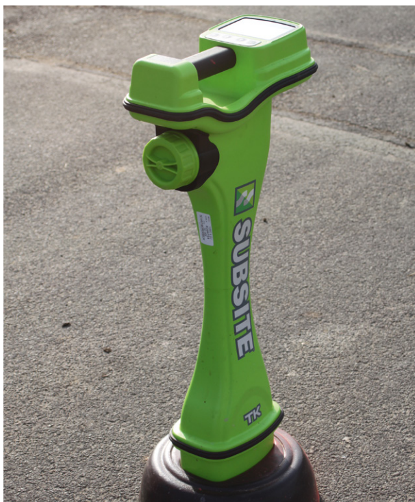
Ortung von Wasserleitungen im Rahmen des Breitbandausbaus. Quelle: TÜV Rheinland Consulting GmbH
