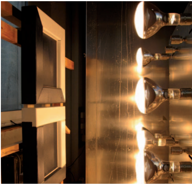
Abbildung 3: Künstliche Bewitterung von Rahmenverbindungsvarianten
