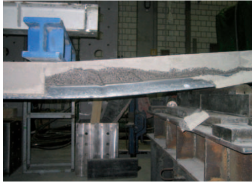
Abbildung 2: Kombiniertes Längsschub-Quer-kraft Versagen der Leichtbeton-Versuchskörper
