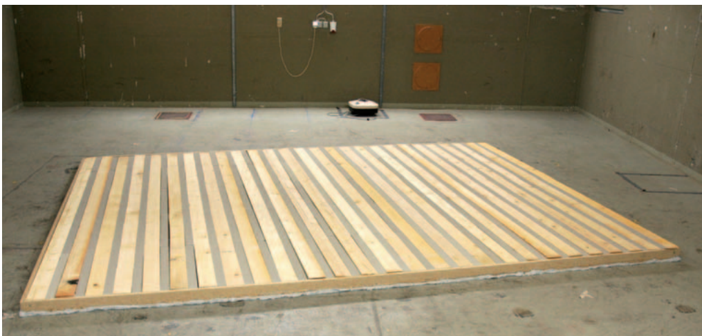
Abbildung 1: Messung eines periodischen Schallabsorbers im Hallraum
