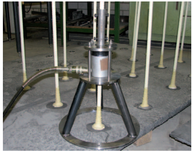
Abbildung 4: Reihenversuche an geklebten GFK-Verbindungsankern [Foto: TU Kaiserslautern]
