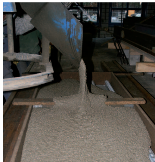
Abbildung 1: Fließverhalten des entwickelten selbstverdichtenden Leichtbetons bei der Herstellung
