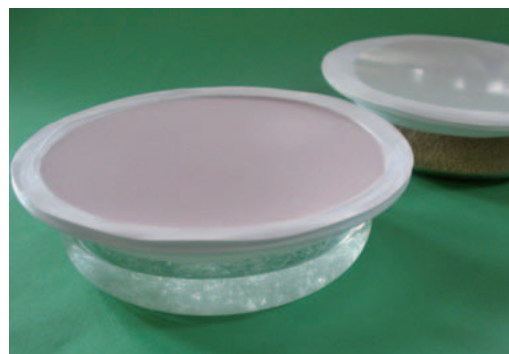
Abbildung 1: Untersuchung des Wasserdampfdiffusionsverhaltens von Folien
