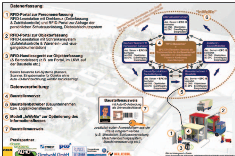
Abbildung 3: RFID-Baulogistikleitstand, nach Helmus, BUW
