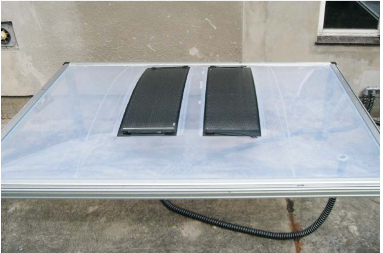
Freibewitterungsprüfstand des ETFE-Kissen-Prototyps mit außenliegenden PV-Modulen
