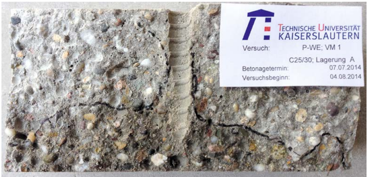
Normalfester Beton wurde in unterschiedlichen Lagerungsbedingungen auf Wasserundurchlässigkeit überprüft.
