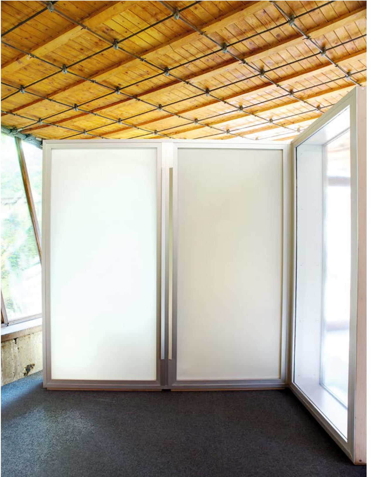
Abbildung 4: Testaufbau mit transluzentem, opakem und transparentem Fassadenelement
