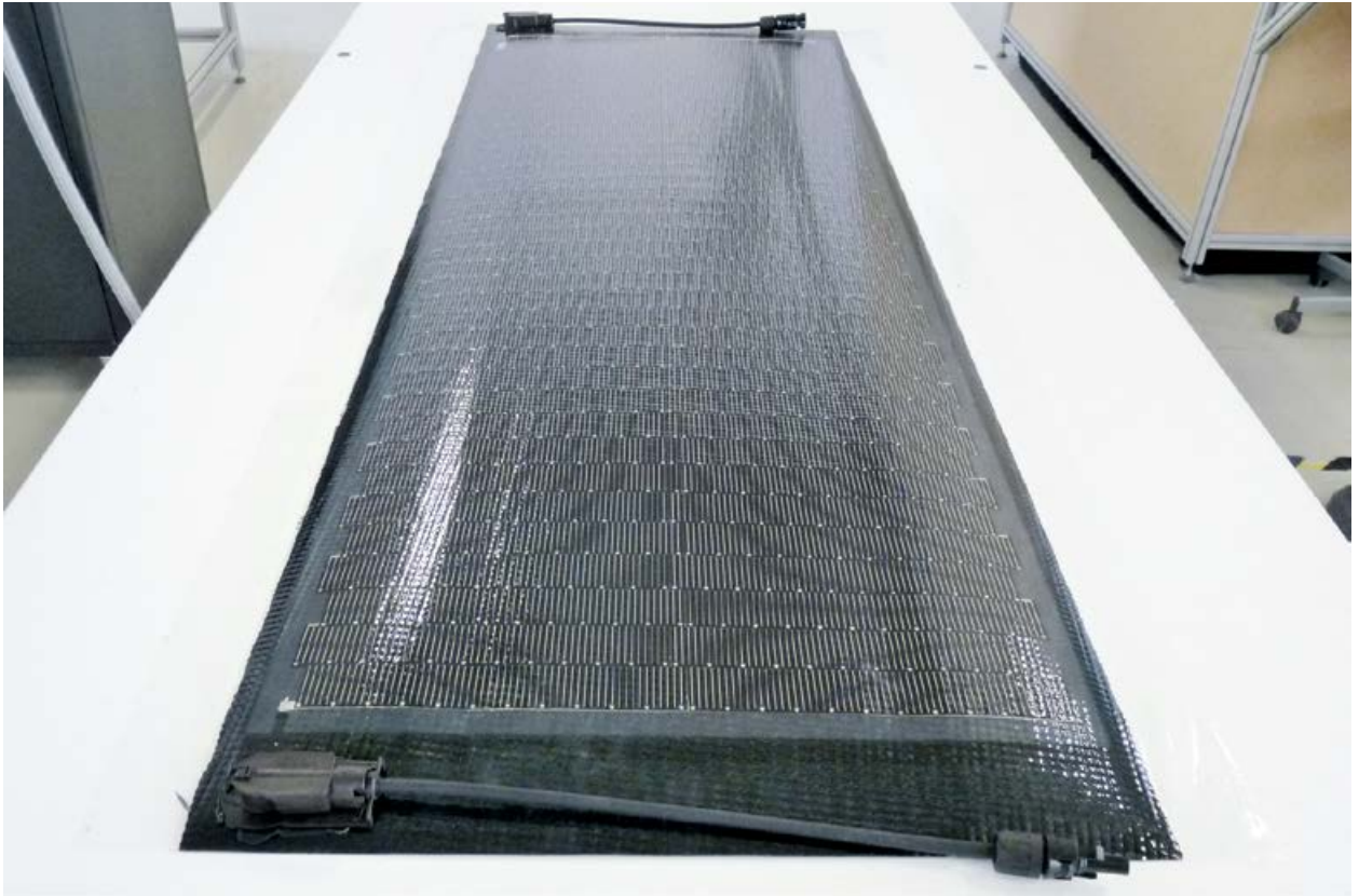
PV-Modul mit ETFE-Streifen an den Modulrändern zur Aufbringung auf die ETFE-Kissen-Prototypen
