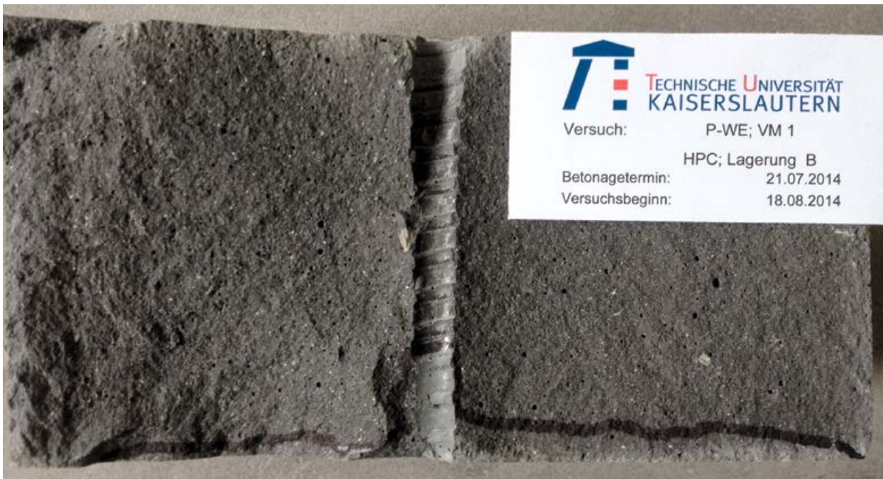
Hochfester Beton wurde auf Wasserundurchlässigkeit überprüft.
