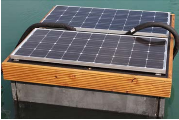
Großdemonstrator im Wasser mit Anlagentechnik zur autarken Stromversorgung der Messapparatur
