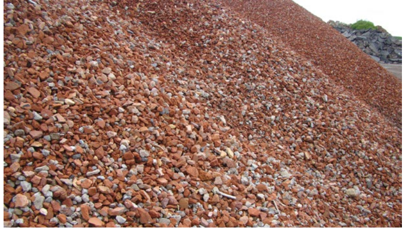
Abbildung 102: Recycling-Baustoffe aus Mauerwerkbruch
