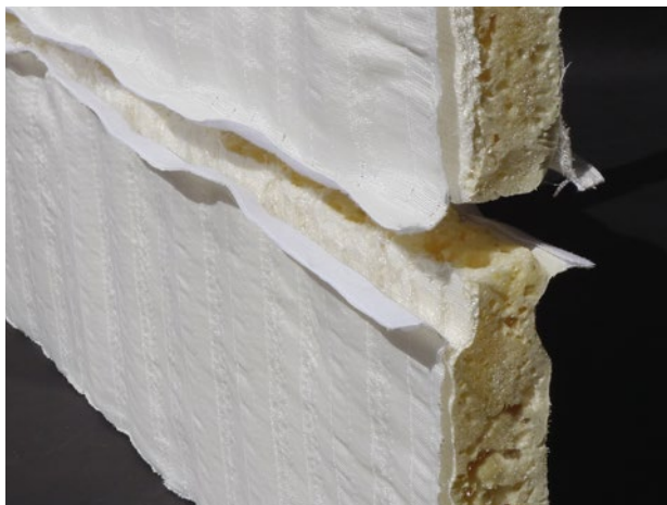
Abbildung 49: 3dTEX – Fügung über Klettverschlüsse; hinterlüftete Leichtwandelemente aus geschäumtem zweilagigen Abstandsgewebe
