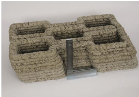
Abbildung 117: Durch Extrusion von Holzleichtbeton gefertigtes Testobjekt mit Überhang von 26%
