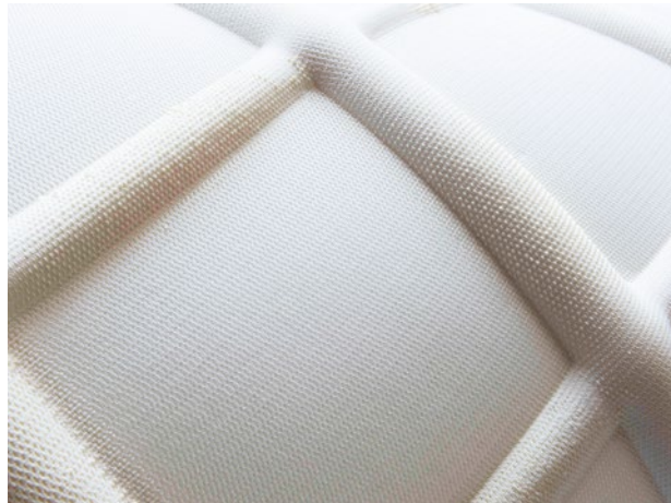
Abbildung 47: 3dTEX – Leichtwandelement aus geschäumtem einlagigen Abstandsgewirke
