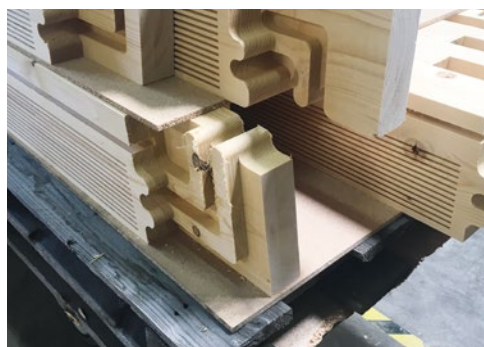
Abbildung 6: Fertig bearbeitete Vollholzbalken. Jeder Balken hat eine individuelle Nummer und wurde „just in sequence“ gefertigt.
