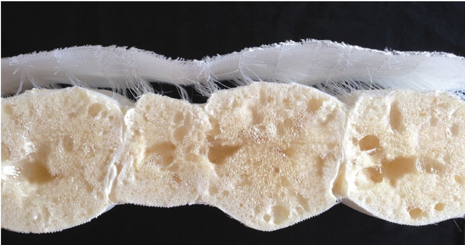
Abbildung 46: 3dTEX – Geschäumtes Abstandsgewebe
