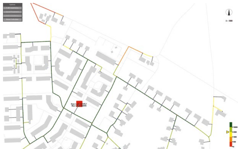
Abbildung 14: Automatische Generierung und Bewertung des Wärmenetzes in Abhängigkeit von der Position der Heizzentrale (physisches Objekt auf der Tischoberfläche – rot markiert)
