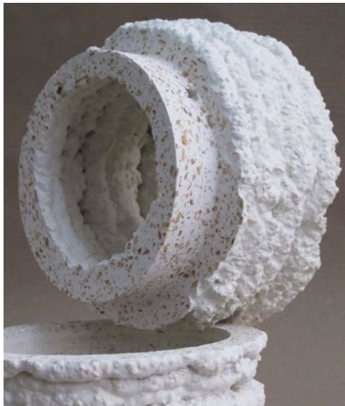
Abbildung 119: Durch Extrusion additiv gefertigtes und mittels Fräsen partiell subtraktiv nachbearbeitetes Testobjekt aus Holzleichtbeton
