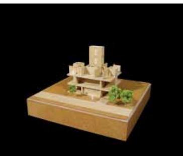
...die vorgefertigten Holzgeschosse werden an den Treppenhauskern angehängt.
