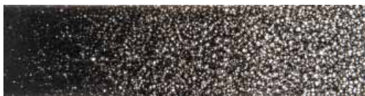
Retikulierter Polyuerthan Schaum, Quelle: ILEK
