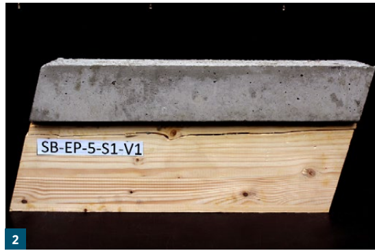
1 Holz-Beton-Verbund-Decke mit zwischen den Rippen angeordneten TGA-Registern 2 Mit Epoxidharzmörtel geklebter Scherversuchskörper nach Scherversagen des Holzes 3 Zwischen den Balken angeordnetes TGA-Register 4 Der untersuchte Polyurethan-Klebstoff
