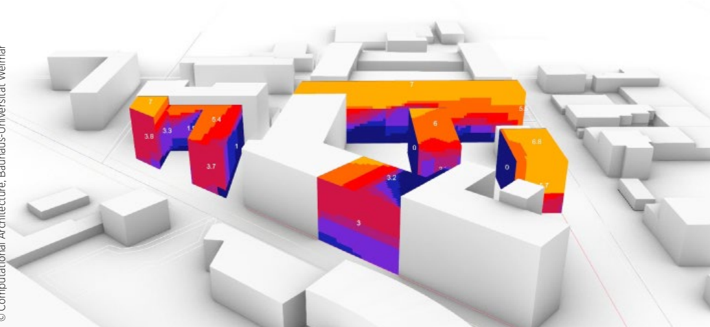
Solaranalyse an einem Wintertag (1. Februar), die bewertet, wie sich die Verschattung der Nachbarhäuser auf die Neuplanung (bunte Gebäude) auswirkt (Zahlen = Anzahl der Stunden mit Lichteinfall der kompletten Fassade; Farben = Sonneneinstrahlung an den verschiedenen Teilen der Gebäudehülle)
