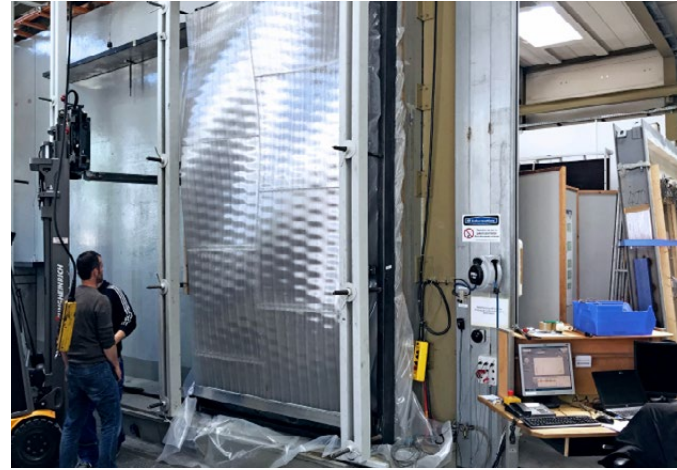
Standstabilitätstest für die Zustimmung im Einzelfall. Wind- und Soglasten wurden an einem 1:1 Fassadenausschnitt (4 x 1,8m) am IFT Rosenheim erfolgreich getestet.
