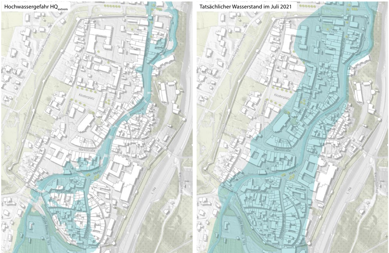
Abb. 22: Gegenüberstellung des HQ extrem mit dem tatsächlichen Wasserstand im Juli 2021 in der historischen Altstadt von Bad Münstereifel (Quelle: RHA 2022 nach Kreis Euskirchen 2021)
