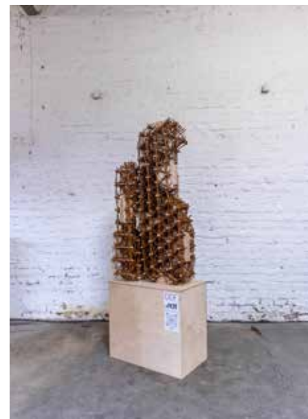
Digital fabrizierte Bauteile aus dreidimensional geflochtenen Weidenruten, die während der Workshop-Woche auf dem Pop-up Campus gemeinsam mit Studierenden entwickelt wurden. Alle Fotos: © DDF KIT
