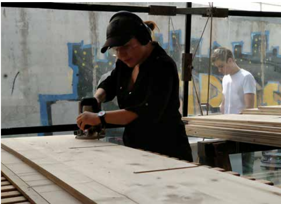
Oben: Die Platten für den Prototyp werden geschliffen und poliert. © GREENbimlabs GmbH
