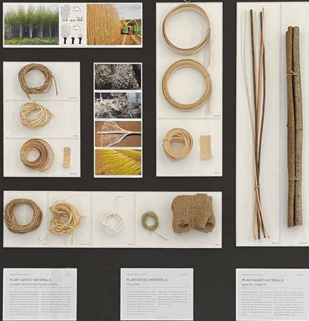
Materialsammlung zu schnell nachwachsenden Rohstoffen wie Weide, Hanf, Sisal und Rattan. © DDF KIT
