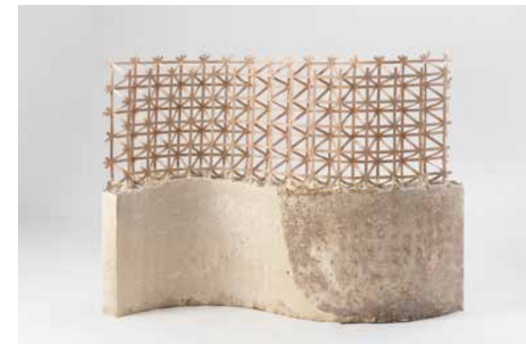
Geschwungene Myzel-Trennwand mit teilweise sichtbarem Furniergitter. © Nicolas Wefers
