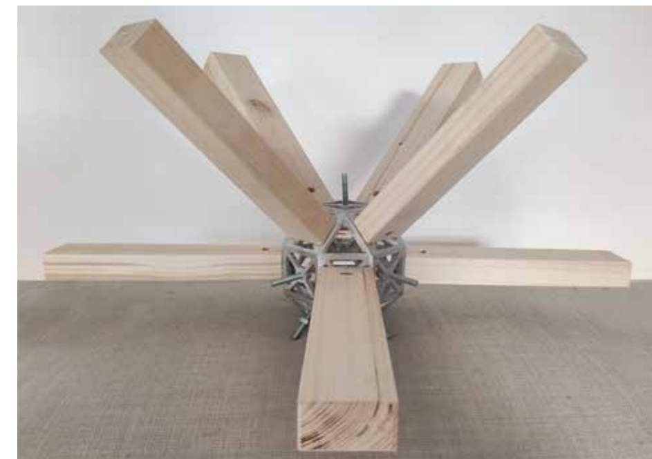
Knotenpunkt-Prototyp mit angeschraubten Holzstäben 28 x 48 mm. © Lukas Kirschnick
