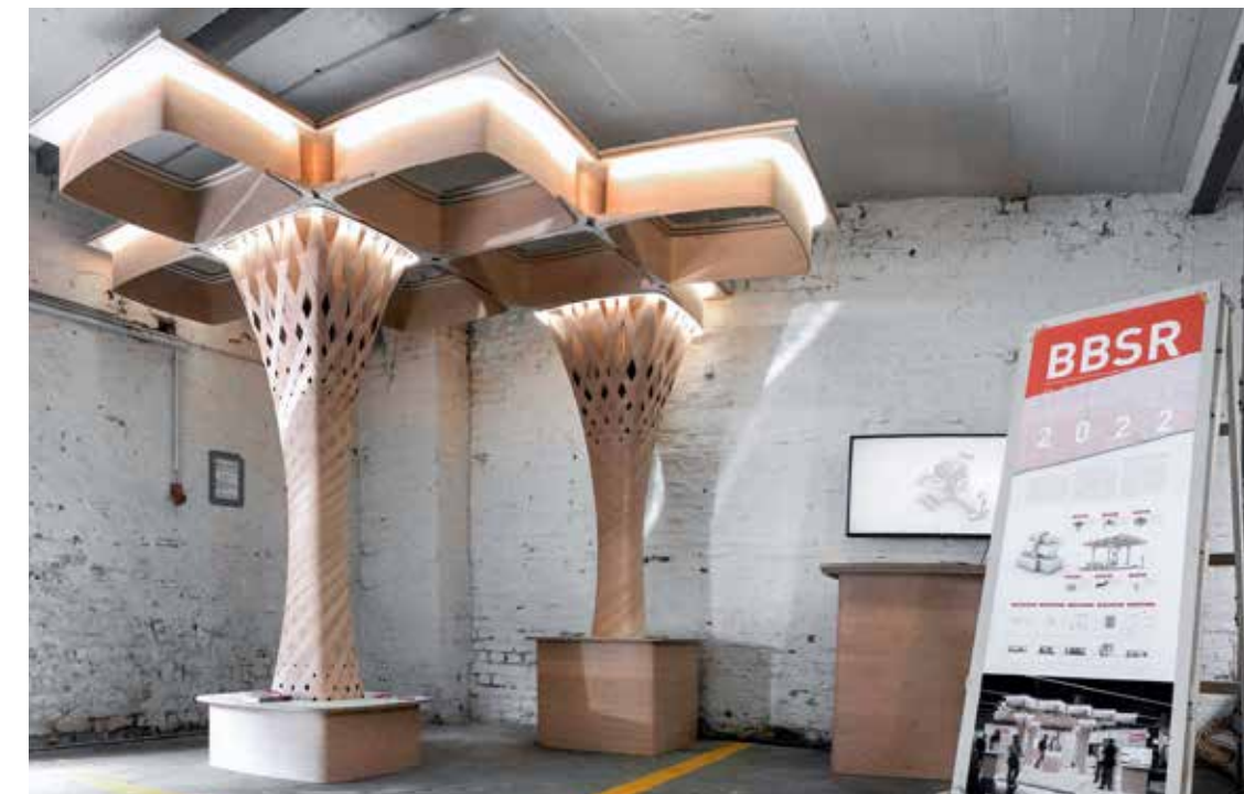
Modulare Struktur aus robotisch gewickelten Stützen und Deckenelementen aus Furnierholz, angepasst an die Gegebenheiten vor Ort. © EDEK, Universität Kassel
