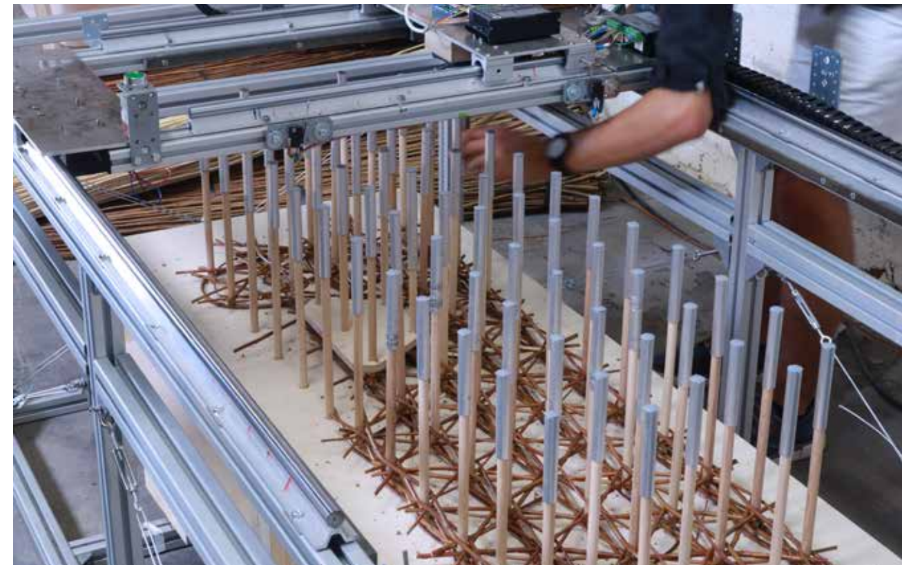
Digitale Weidenflechtmaschine auf dem Pop-up Campus. © DDF KIT
