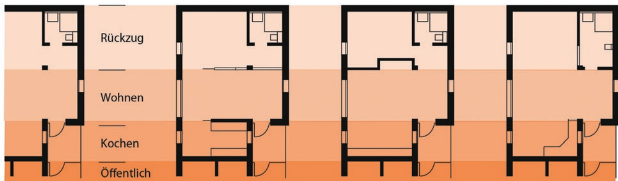
Verschiedene Grundrissvarianten mit geschlossener oder offener Küche bzw. mit geschlossenem oder offenem Schlafbereich
