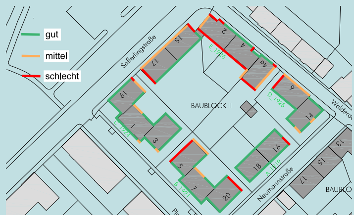
Abb. 82 Auszug aus dem Schadenskatalog für die Natursteinsockelmauern Quelle: Semmler, Thomas; Cemodanov, Sandra (2014)
