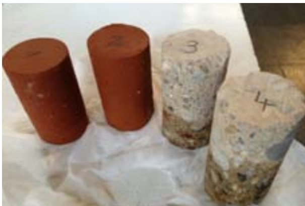
Abb. 100 Bestimmung des Wasseraufnahmekoeffizienten der Bohrkerne (Fotos: Höflich)
