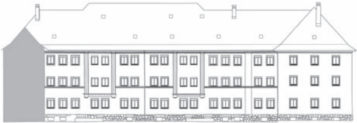
Abb. 102 Häusergruppe an der Walderdorffstraße (Fassade zum Innenhof des Blocks II). Hier wurden exemplarische Schallschutzmessungen zwischen den Geschossen und zwischen benachbarten Wohnungen durchgeführt. (Zeichnung: Zeitler/Wittmann)
