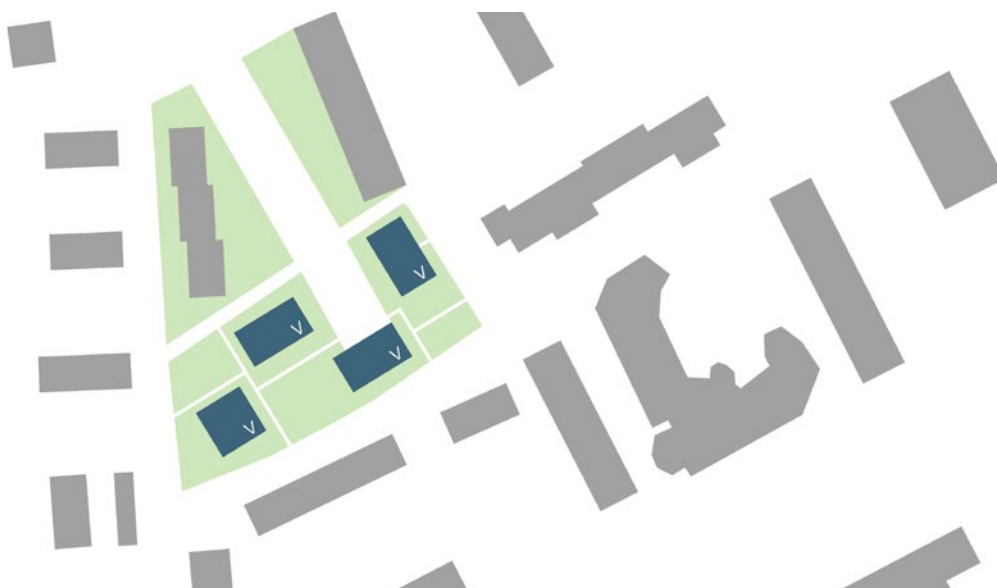
Am Stadtwald, Offenburg: 5-geschossige Gebäude, versetzt angeordnet; Darstellung: Weeber+Partner
