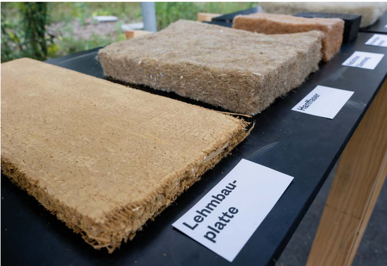
Abbildung 35: Materialproben, Lehmplatte und Naturfaserdämmungen [Quelle: STÖBE. Die Agentur für Kommunikation GmbH]
